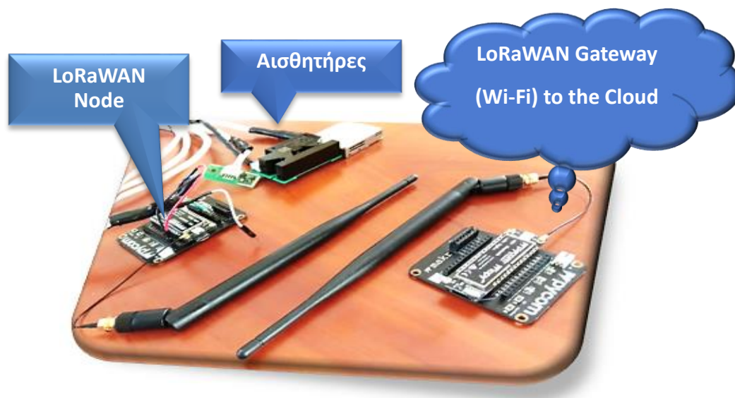
Εικόνα 36β : Πειραματική διάταξη LoRaWAN node με συνδεδεμένους αισθητήρες και τη LoRaWAN Gateway σε σύζευξη με τις κεραίες τους.
