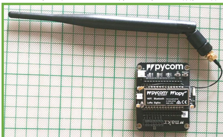
Εικόνα 33α : Αναπτυξιακή πλακέτα Pycom με το LoPy 4 και δεξιά η υλοποίηση της gateway με το LoPy4
