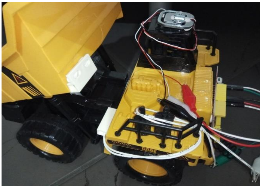
Εικόνα 12. Τηλεκατευθυνόμενο φορτηγό όχημα με Seeduino
