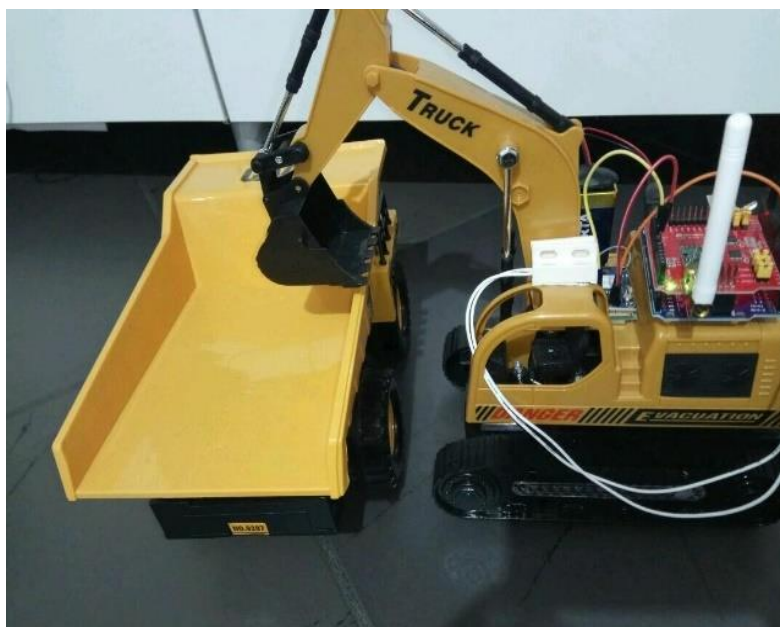
Εικόνα 11. Τηλεκατευθυνόμενος Εκσκαφέας με ασύρματο module Arduino – Dragino
