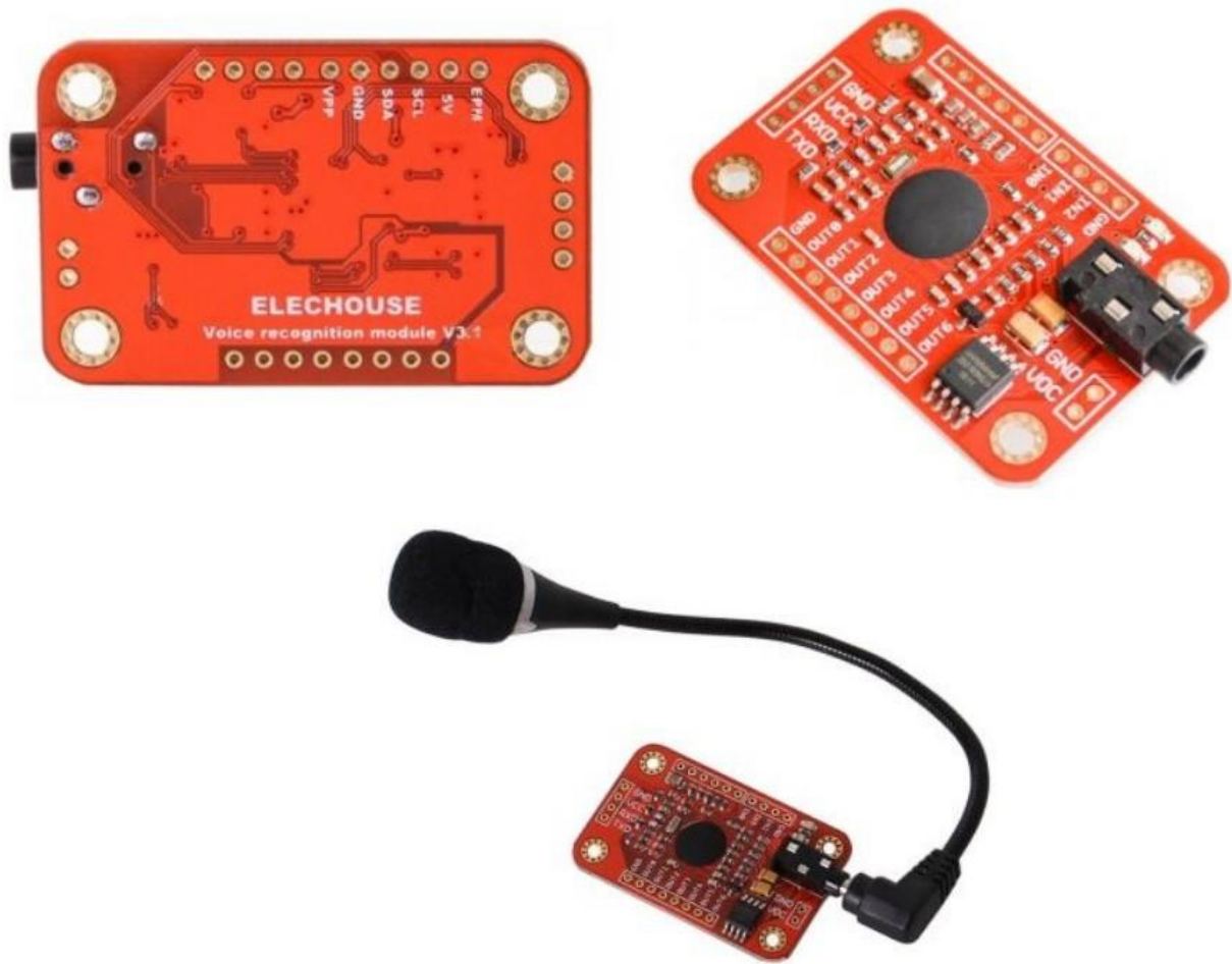
Εικόνα 45: Απλός αισθητήρας αναγνώρισης φωνής του εμπορίου.
