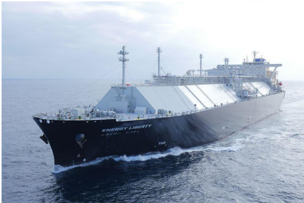
Εικόνα 5: Τυπικό πλοίο μεταφοράς LNG με δεξαμενές μεμβράνης
