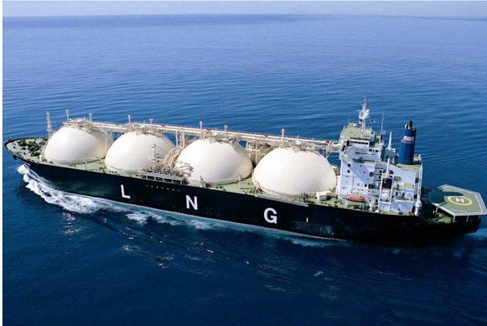
Εικόνα 6: Τυπικό πλοίο μεταφοράς LNG με σφαιρικές δεξαμενές
