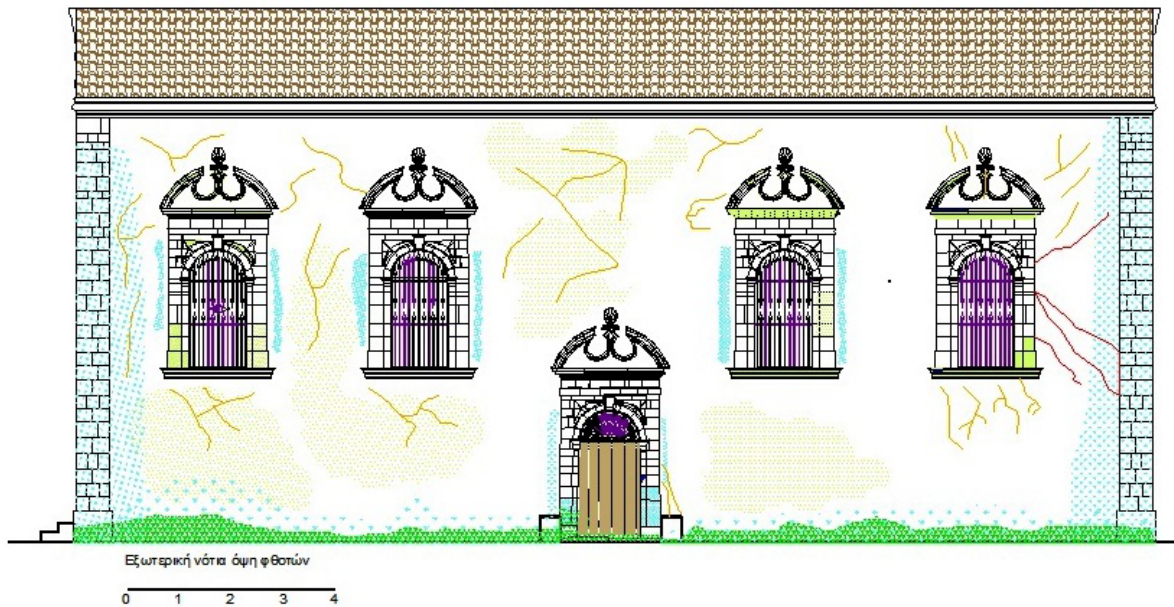
Σχέδιο 13. Εξωτερική Νότια όψη φθορών. Κ. Σούλτος
