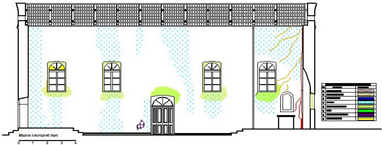
Σχέδιο 15. Εσωτερική Βόρεια όψη φθορών.
