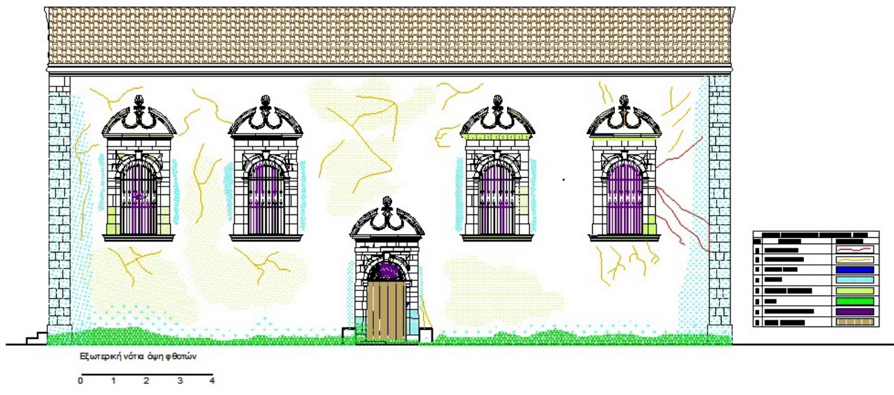
Σχέδιο 13. Εξωτερική Νότια όψη φθωρών.
