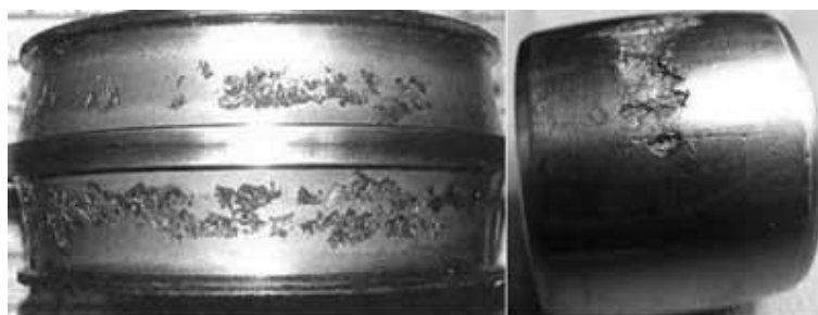
Σχήμα 54- Σφάλματα στα ρουλεμάν ηλεκτρικής μηχανής
