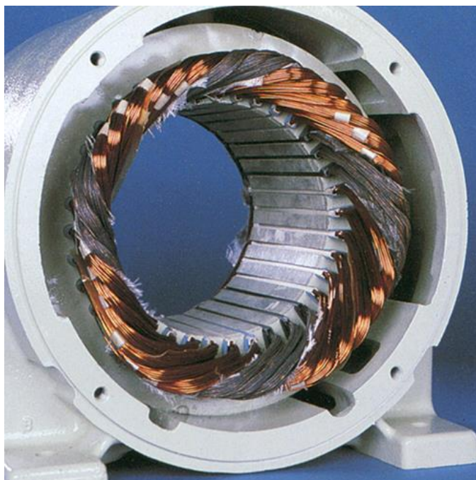
Σχήμα 53- Σφάλμα μόνωσης στα τυλίγματα στάτη ηλεκτρικής μηχανής.
