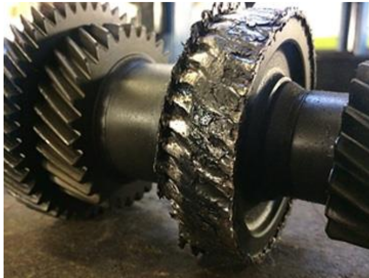
Σχήμα 56- Σφάλματα σε γρανάζια ηλεκτρικών μηχανών
