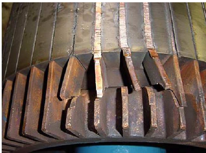
Σχήμα 55- Σφάλματα στις μπάρες βραχυκύκλωσης επαγωγικής μηχανής.
