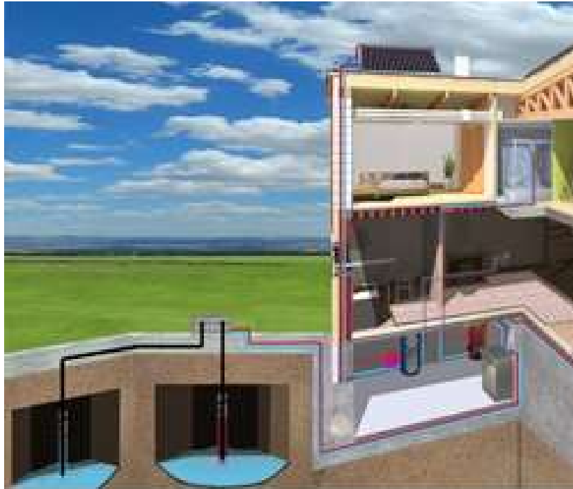
Εικόνα4.53: Ανοικτό κύκλωμα γεωθερμικού εναλλάκτη Πηγή: zeon.com.gr
