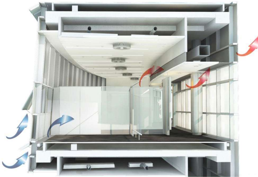
Εικόνα5.6: Φυσικός αερισμός του κτηρίου. Πηγή: utunisphere.com
