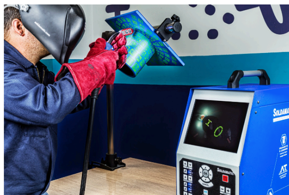
Σχήμα 11: Η Πλατφόρμα προσομοίωσης συγκόλλησης Soldamatic
