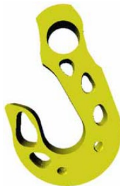
Εικόνα 9.4.2.3: Αποτέλεσμα τοπολογικής βελτιστοποίησης με γνώμονα την κατασκευή αντικειμένου μέσω χύτευσης (Dassault Systemes, 2021).
