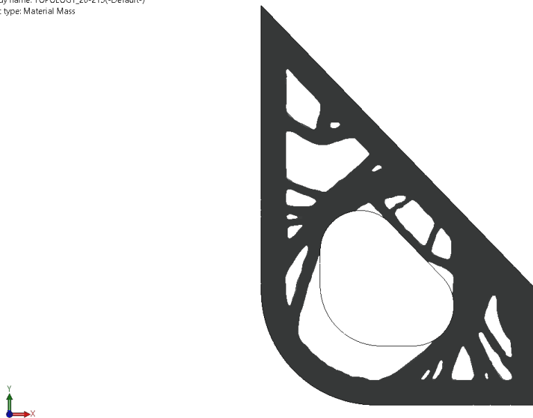
Εικόνα 10.9.3: Το εξομαλυμένο πλέγμα της δεύτερης εκδοχής του ελάσματος.
