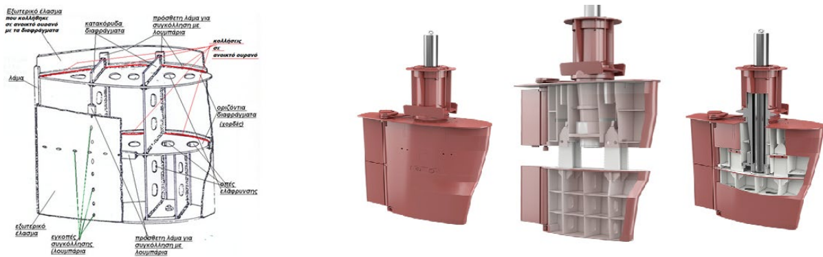
Εικόνα 14.4.2: Αριστερά: Ονοματολογία κατασκευαστικών στοιχείων πηδαλίου (Χατζηκωνσταντής, 2017) | Δεξιά: Τρισδιάστατη απεικόνιση κατασκευαστικών στοιχείων πηδαλίου (Kongsberg, 2024).
