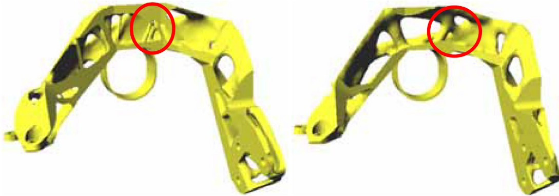
Εικόνα 9.4.2.2: Βελτιστοποιημένη τοπολογία εξαρτήματος με (Αριστερά) και χωρίς (Δεξιά) προσδιορισμό ελαχίστου πάχους (FE-DESIGN GmbH, 2014).
