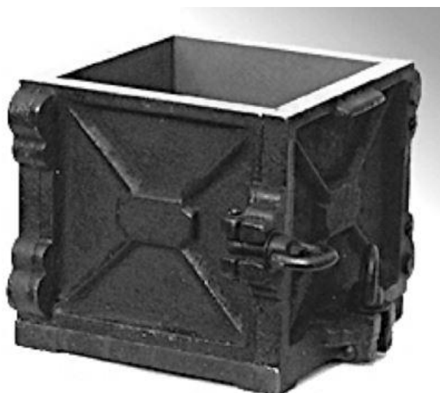
Εικόνα 20: Μήτρα για δοκίμιο σκυροδέματος 15*15 [51]
