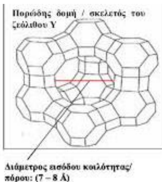
Εικόνα 7: Πορώδης δομή ζεόλιθου [41]
