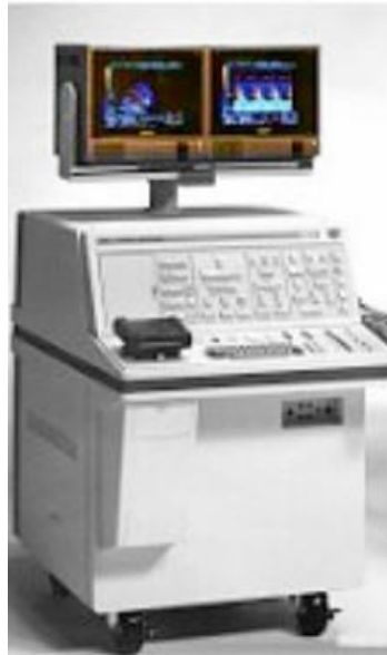
Εικόνα 5: Το πρώτο σύστημα έγχρωμης ροής Doppler πραγματικού χρόνου από την Aloka (SSD-880) στην Ιαπωνία (Woo, Dr.J. 2008)
