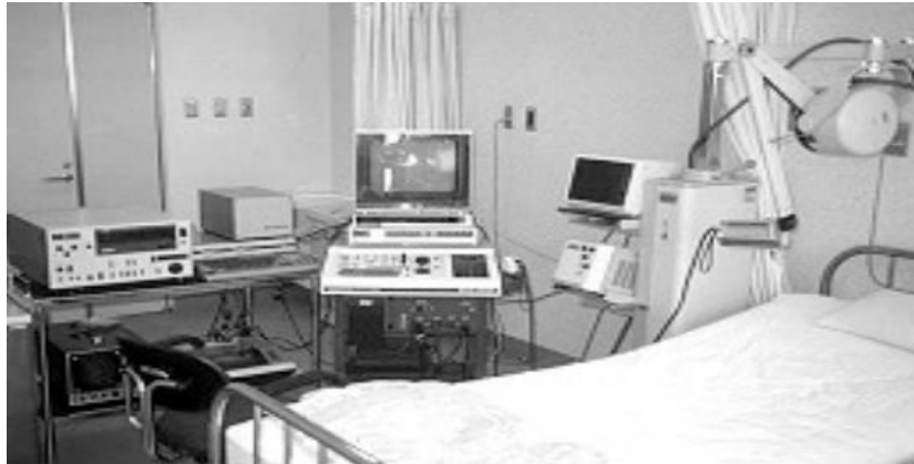
Εικόνα 6: Το τρισδιάστατο σύστημα του Kazunori Baba στα μέσα του 1980 με τον γραμμικό ηχοβολέα να είναι τοποθετημένος σε αρθρωτό βραχίονα για την ανίχνευση της θέσης (Woo, Dr.J. 2008)
