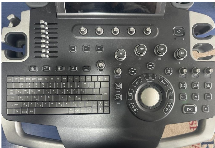
Εικόνα 21: Κονσόλα χειρισμού με τα διάφορα κουμπιά που ενεργοποιούν λειτουργίες όπως έγχρωμη απεικόνιση (CF) ή παλμικό Doppler (PW), καθώς επίσης και άλλα εξαρτήματα όπως πληκτρολόγιο και trackball
