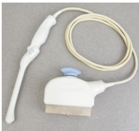
Εικόνα 16: Κολπικός Ηχοβολέας – Χρησιμοποιείται για γυναικολογικούς σκοπούς και κατά την κύηση κατά τη διάρκεια του πρώτου τριμήνου
