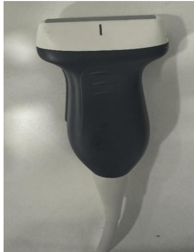
Εικόνα 18: Γραμμικός Ηχοβολέας – Χρησιμοποιείται για τη διάγνωση αγγειακών παθήσεων ή για τον έλεγχο του θυρεοειδούς αδένος
