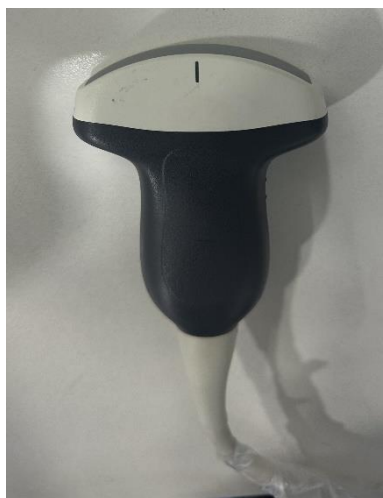
Εικόνα 17: Κοιλιακός Ηχοβολέας – Χρησιμοποιείται για διαγνώσεις σε όργανα της κοιλιακής περιοχής (π.χ. νεφρά, συκώτι)
