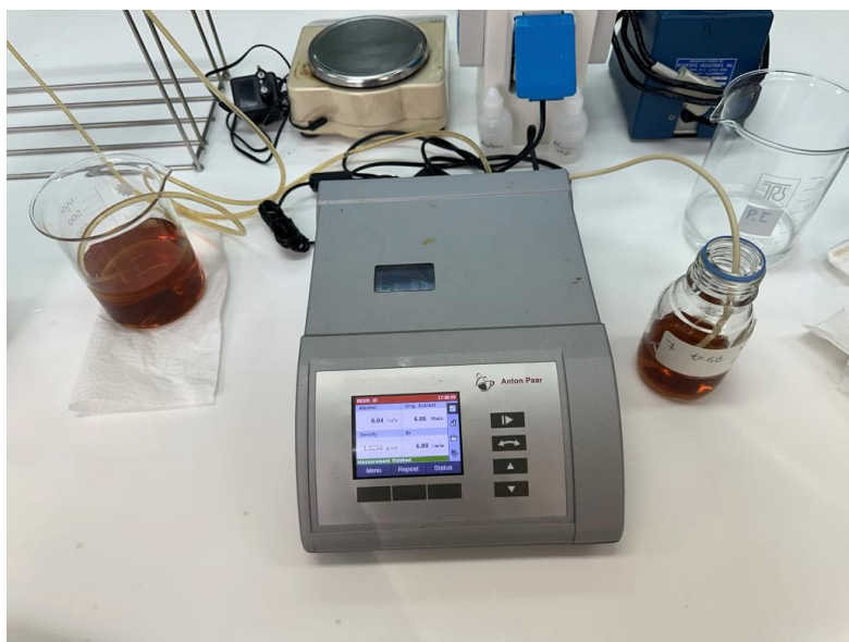
Εικόνα 99 : Μετρήσεις με Alex 500 Anton Paar
