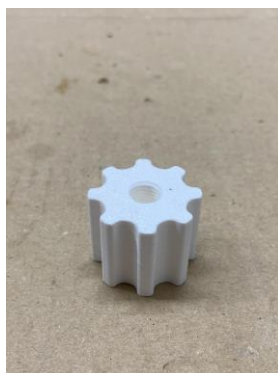
Εικόνα 36. γρανάζι για την κίνηση στον z άξονα
