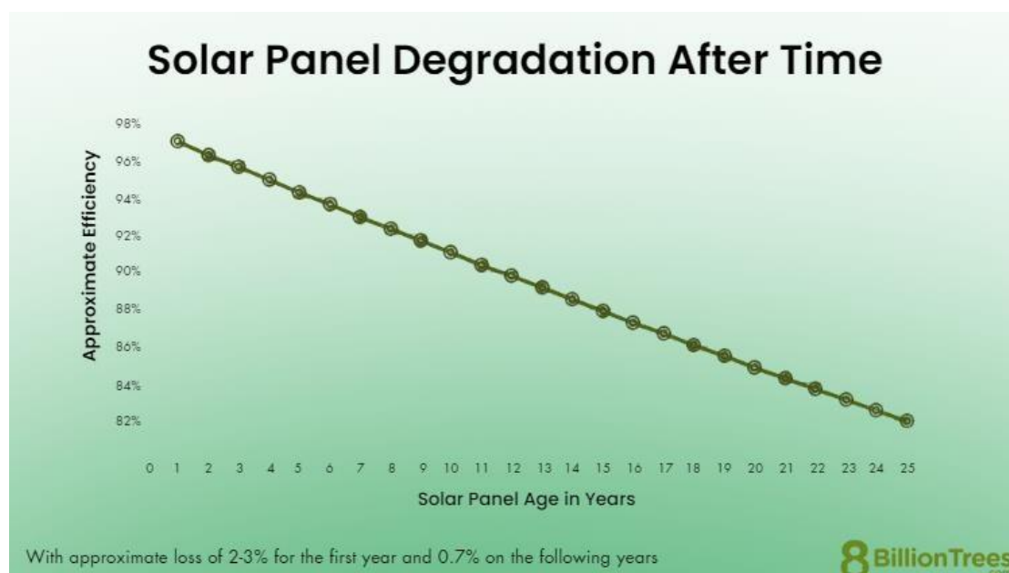
Εικόνα 6.2.B: Διάγραμμα μείωσης της απόδοσης των φωτοβολταϊκών πάνελ σε συνάρτηση με τον χρόνο (8billionTrees.com, 2022)
