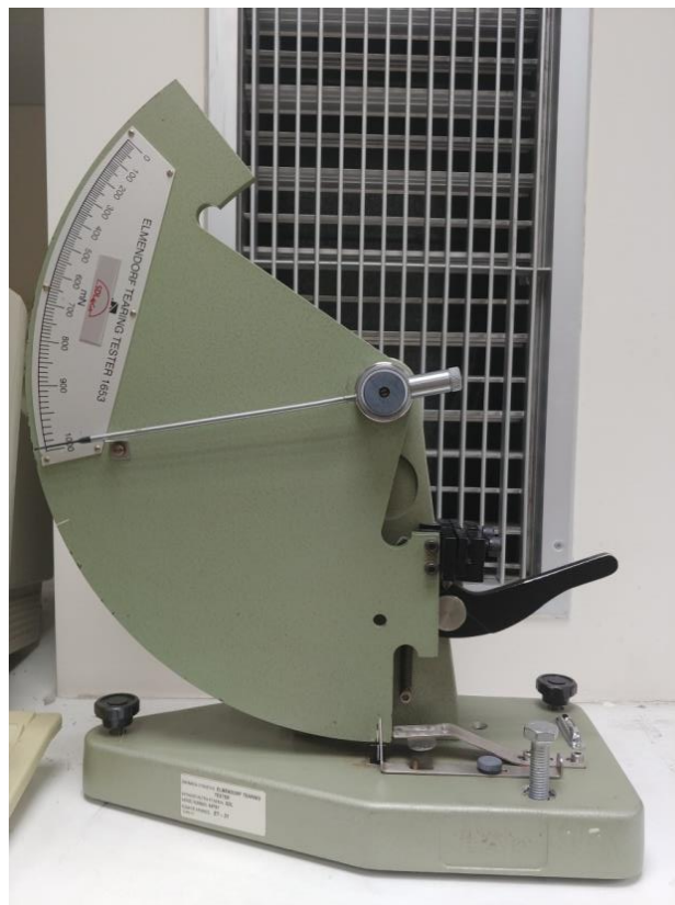
Εικόνα 15 Elmendorf Tearing Tester
