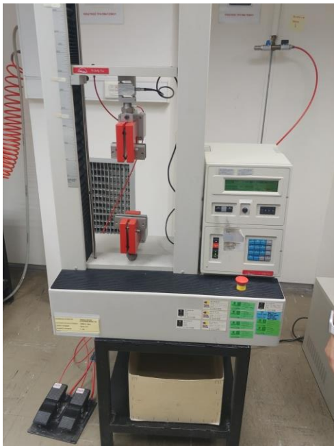
Εικόνα 11 Δυναμόμετρο (Alphatens Model 400).
