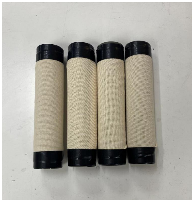
Εικόνα 19 Δοκίμια για συσκευή Pilling Box
