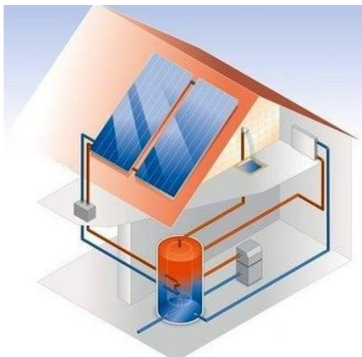
Σχήμα 4-10: Ηλιοθερμικό σύστημα εγκατεστημένο σε κατοικία, το οποίο αποτελείται από τους ηλιακούς συλλέκτες, τον ταμιευτήρα ηλιακής θέρμανσης (buffer) και τους ηλιακούς ελεγκτές (solar station) [73]
