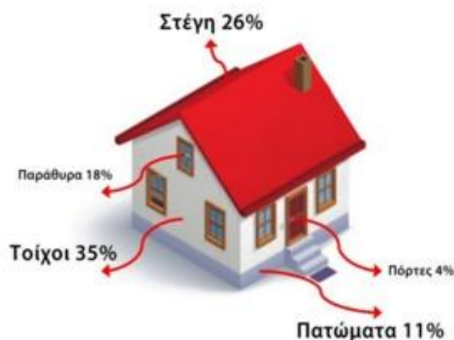
Σχήμα 3-7: Απώλειες θερμικής ενέργειας σε κατοικίες [90]
