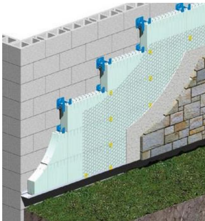
Σχήμα 4-2: Σύστημα εξωτερικής θερμοπρόσοψης από εξηλασμένη πολυστερίνη [29]
