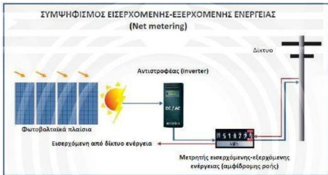
Σχήμα 4-5: Αρχή λειτουργίας φωτοβολταϊκού συστήματος Net Metering, το οποίο εφαρμόζεται κατά βάση σε κτίρια (σπίτια, επαγγελματικά κτίρια πάσης φύσεως, ξενοδοχεία, βιομηχανικά κτίρια, αποθήκες χονδρικής και logistics κλπ). Το Net Metering είναι μια μέθοδος ενεργειακού συμψηφισμού μεταξύ της ενέργειας που παράγει ένα φωτοβολταϊκό σύστημα που έχει εγκατασταθεί σε κάποιο κτήριο κατοικίας ή επιχείρησης και της ενέργειας που καταναλίσκεται από τις εγκαταστάσεις του συγκεκριμένου κτηρίου. [33]
