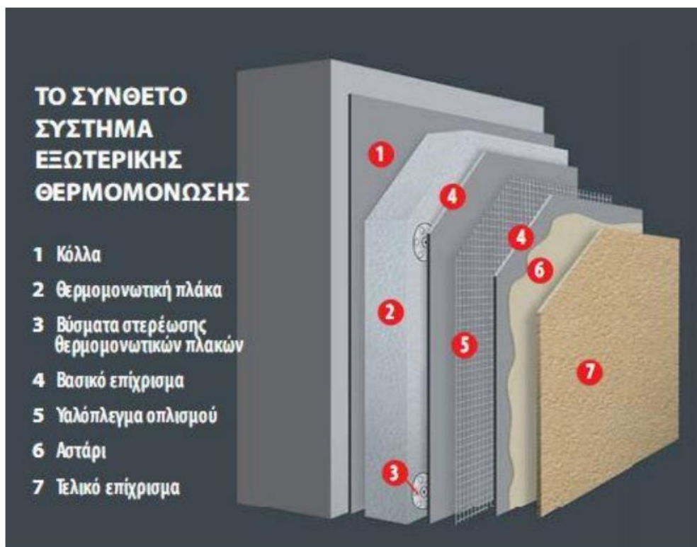
Σχήμα 6-4: Ενδεικτικό εξωτερικό σύστημα θερμομόνωσης [94]
