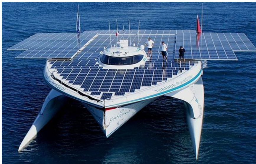
Εικόνα 4-8: Εγκατάσταση Φ/Β συστήματος σε σκάφος [86]
