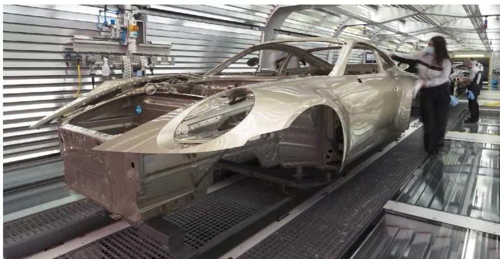
Εικόνα 26: Διαδικασία βαφής και παράλληλος έλεγχος από υπεύθυνο
