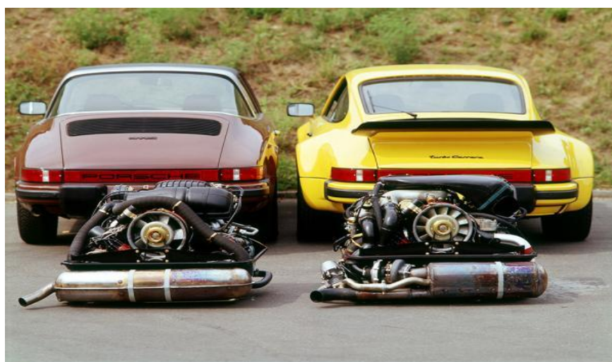
Εικόνα 2 : Η διαφορά μεταξύ της απλής 911(αριστερά) και της τούρμπο (δεξιά)
