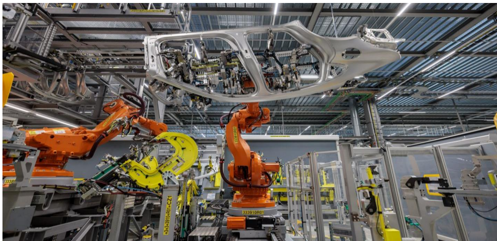
Εικόνα 23: Μεταφορά αμαξώματος αποκλειστικά με ρομποτικούς σύγχρονους βραχίονες
