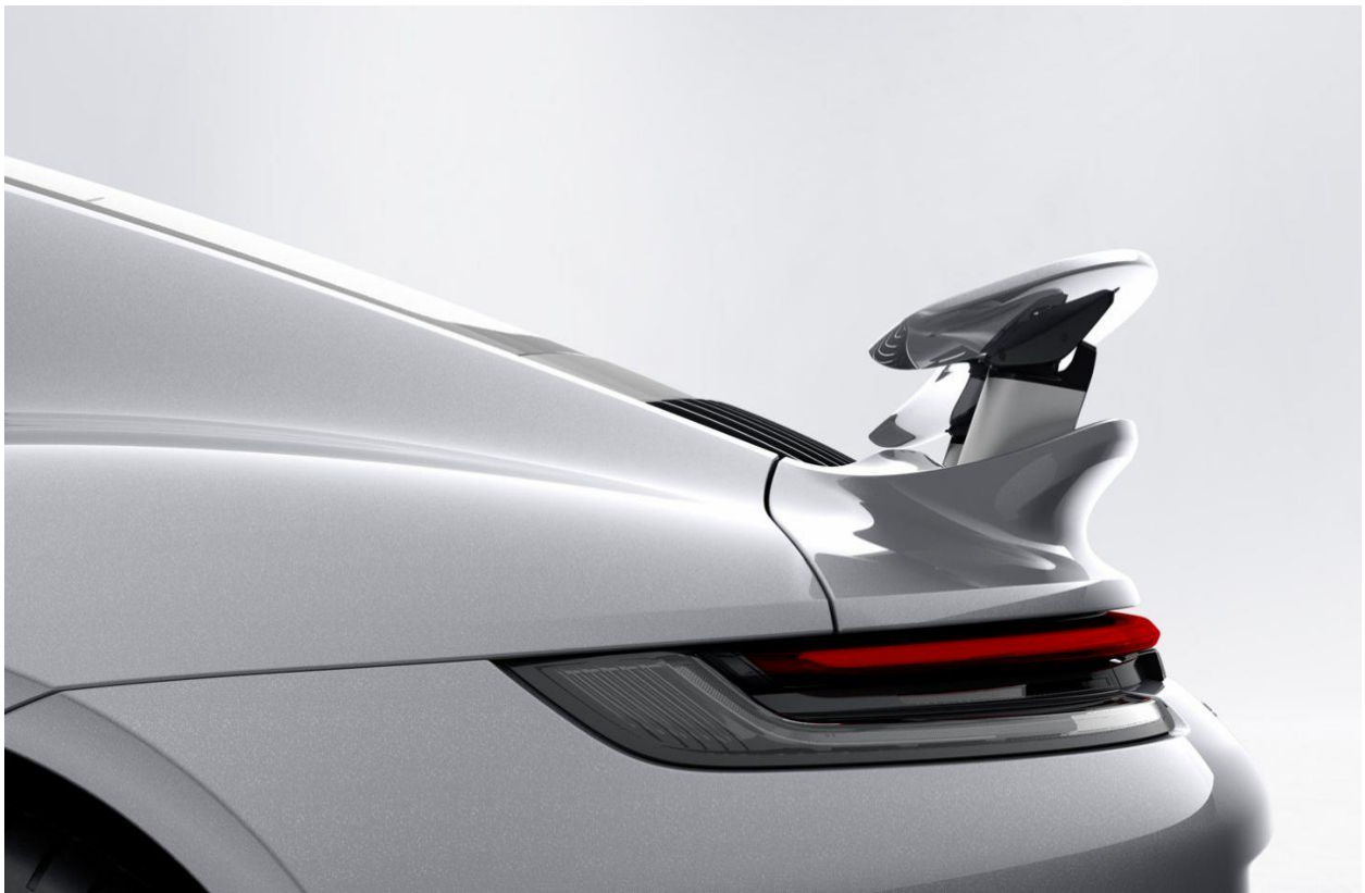
Εικόνα 15: Εικόνα 14: Η αεροτομή στο τελευταίο στάδιο Performance, όταν απαιτείται η μέγιστη κάθετη δύναμη
