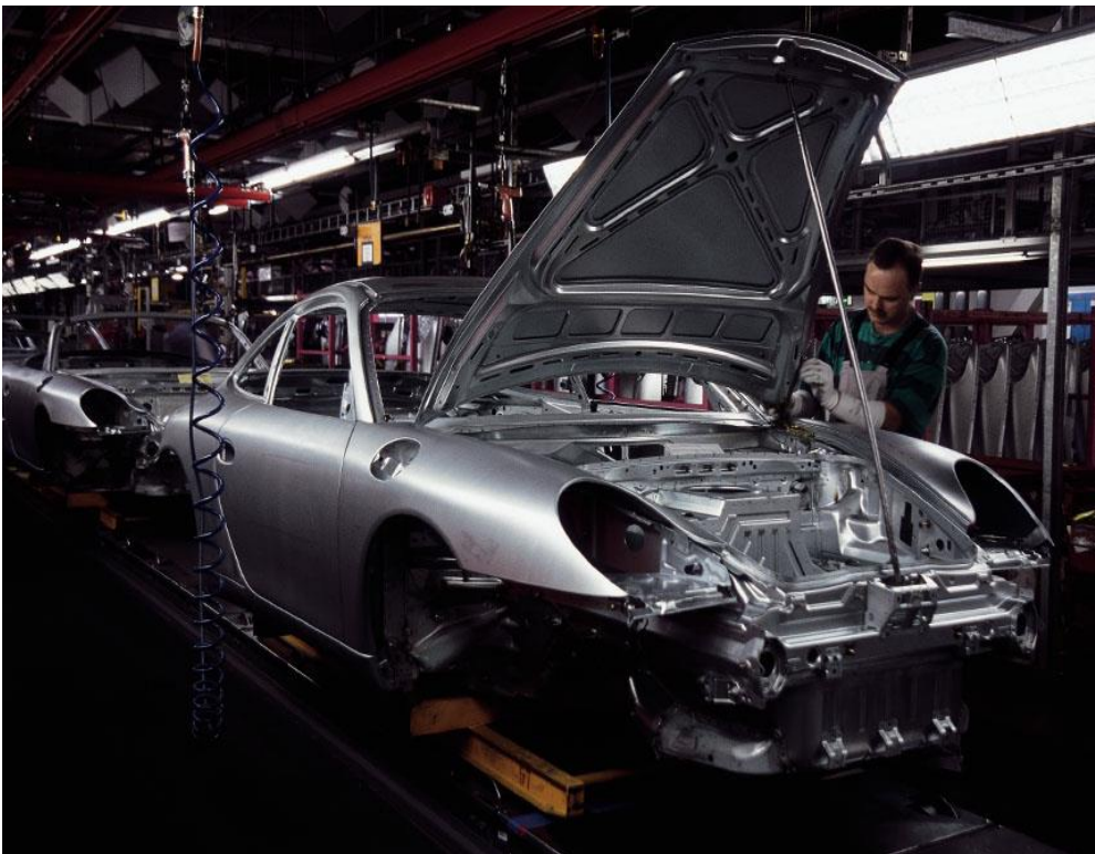
Εικόνα 41: κατασκευή αμαξώματος χειροποίητα
