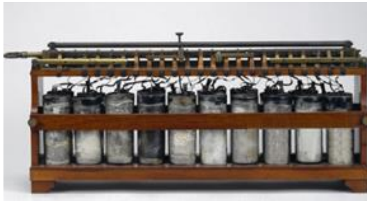
Εικόνα 14 Η πρώτη επαναφορτιζόμενη μπαταρία από τον Guston Plante (1859)
