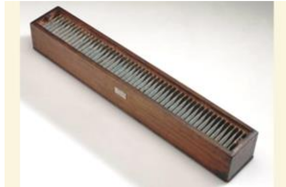
Εικόνα 37 Η μπαταρία του William Cruickshank (1802)
