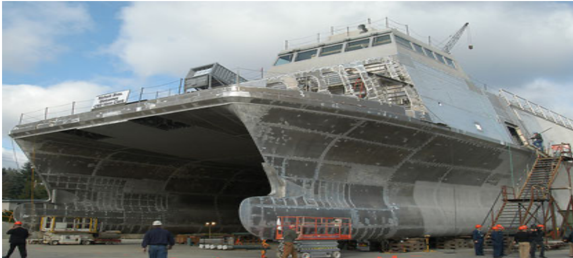
Εικόνα 2.4: Συγκολλημένα με τριβή πάνελ αλουμινίου στο X-Craft στο Nicols Bros. Boat Builders στο Freeland της Ουάσινγκτον. [84]
