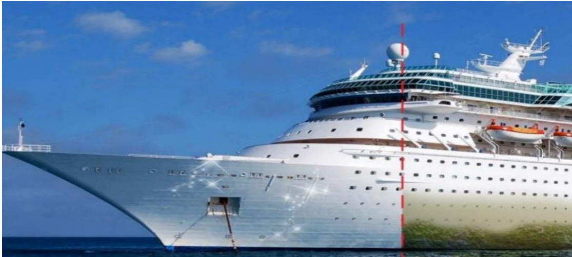
Εικόνα 1.4: Ανάπτυξη ειδικής επίστρωσης με νανοτεχνολογία που εμποδίζει την ανάπτυξη θαλάσσιων οργανισμών, όπως τα βρύα, στο εξωτερικό στρώμα του κύτους των πλοίων από μια ιρανική εταιρεία που βασίζεται στην τεχνογνωσία [71].
