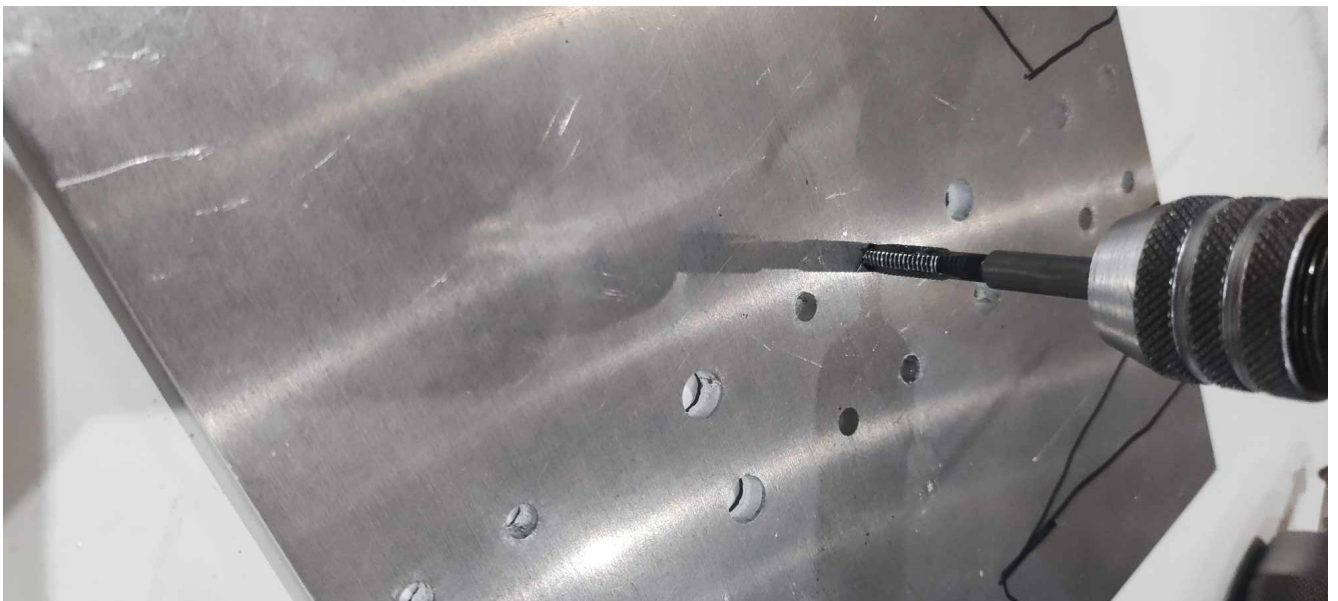
Εικόνα 28 η : Δημιουργία σπειρωμάτων M4 με κολαούζο
