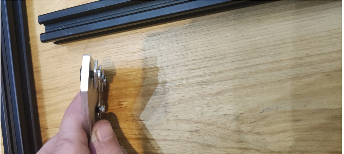
Εικόνα 29 η : Προετοιμασία ειδικού τεμαχίου σύνδεσης με T-NUT
