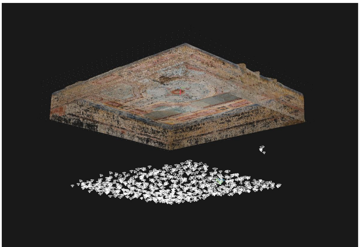
Εικόνα 114. Επεξεργασία και περικοπή μη επιθυμητών στοιχείων που παρεμποδίζουν την τεκμηρίωση της οροφωγραφίας. Πηγή: Προσωπικό αρχείο.
