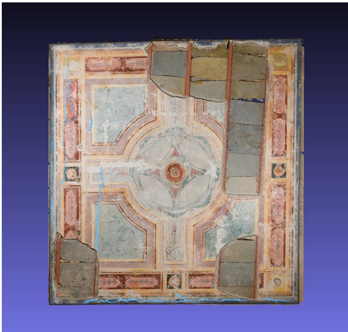
Εικόνα 128. Χαρτογράφηση των ρωγματώσεων της οροφोगραφίας με ανοιχτό – μπλε χρώμα μέσω της εφαρμογής Meshlab, Πηγή: Προσωπικό αρχείο.
