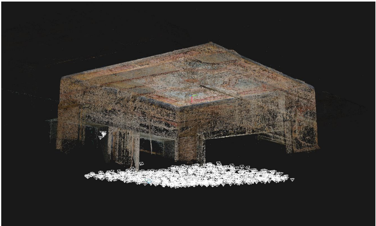
Εικόνα 111. Αναπαράσταση ενός σημείου του δωματίου και της οροφογραφίας στην εφαρμογή Reality Capture. Πηγή: Προσωπικό αρχείο.
