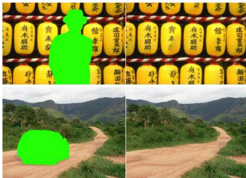
Εικόνα 136. Συμπλήρωση ή αποκατάσταση εικόνας ως εφαρμογή σύνθεσης υφής, οι πράσινες περιοχές (που περιέχουν ανεπιθύμητα αντικείμενα) αντικαθίστανται από τις πιο συνεκτικές περιοχές που εμπεριέχονται στην εικόνα. Πηγή: Purlak Purkait, Bhabatosh Chanda, (2012), «Digital Restoration of Damaged Mural images» pp 3.
