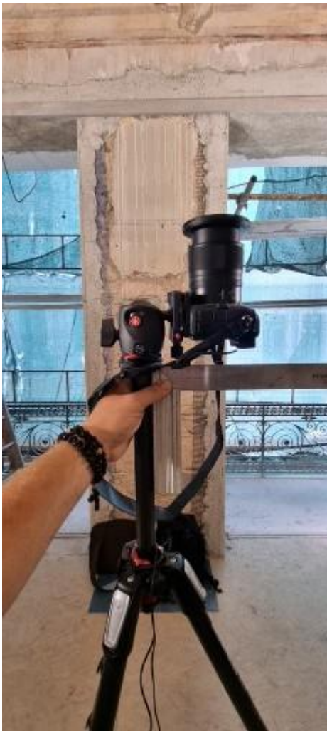
Εικόνα 98. Ρύθμιση φωτογραφικής μηχανής στις 90 μοίρες (γωνίασμα). Πηγή: Προσωπικό αρχείο
