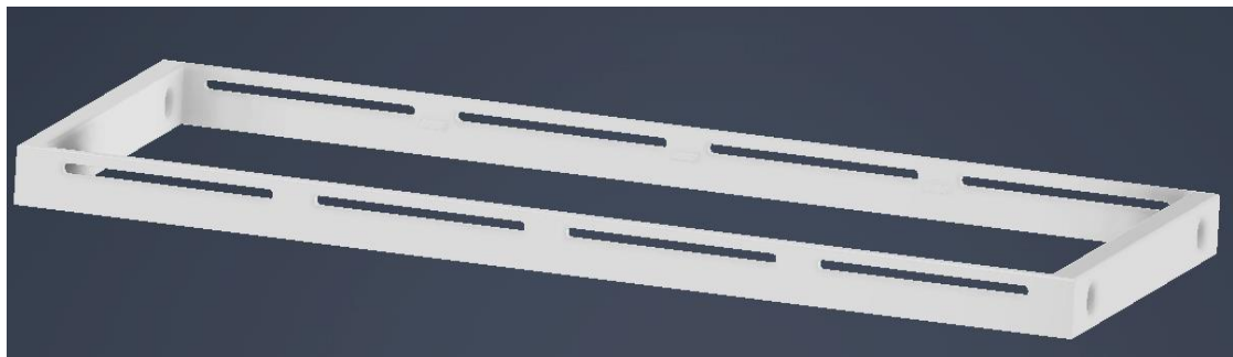
Εικόνα 3.13 Ανοίγματα ύψους 20 χιλιοστών και πλάτους 100 χιλιοστών
