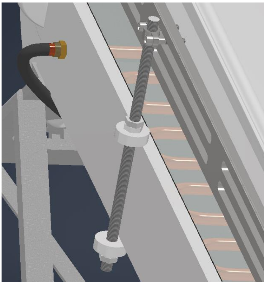
Εικόνα 3.42 Δαγκάνα, στερέωση στον ηλιακό
