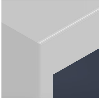
Εικόνα 3.9 Η εξωτερική άνω πλευρά του πλαισίου, μετά την εντολή Fillet
