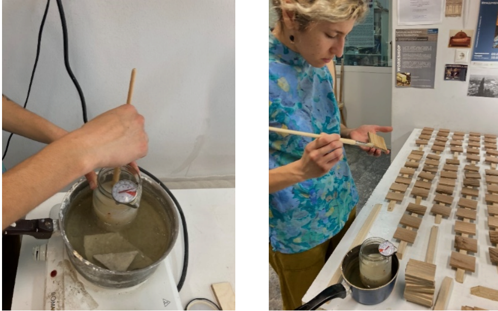
Εικόνα 2.3. Η προετοιμασία και η εφαρμογή του «μονωτικού» υλικού στις ξύλινες επιφάνειες.
