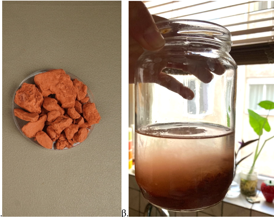
Εικόνα 2.9.α. βόλος Αρμενίας στη φυσική του μορφή και β. το ίζημα που δημιουργείται μετά την ενυδάτωση του βόλου.
