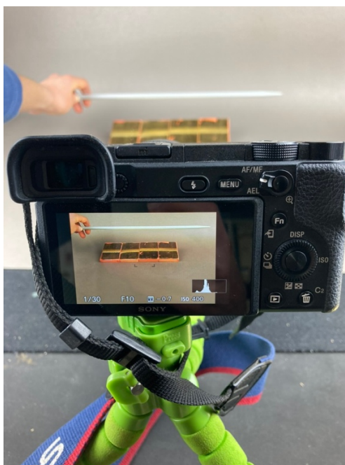
Εικόνα 2.13.. Μέθοδος φωτογράφισης δοκιμίων με χρήση αντανάκλασης από βελόνα πλεξίματος.
