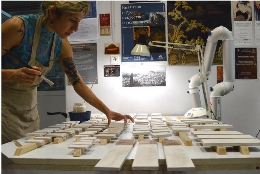
Εικόνα 2.5. Η εφαρμογή του gesso στα ξύλινα δοκίμια.
