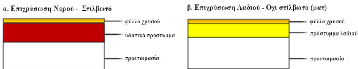
Εικόνα 1 Σχεδιαστική απεικόνιση στρωματογραφίας α. επιχρύσωσης νερού και β. επιχρύσωσης λαδιού (διασκευή από Wu et al. 2020).
