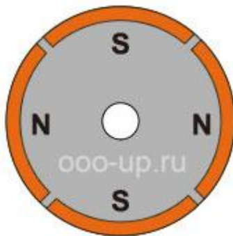
Σχήμα 2.17 Ρότορας με επιφανειακούς μόνιμους μαγνήτες [19]
