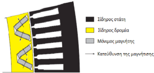
Σχήμα 2.18 Μόνιμοι μαγνήτες σε διάταξη V [54]
