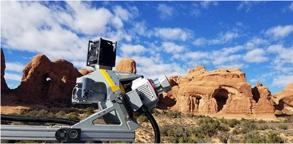
Εικόνα 1: Παράδειγμα Επίγειας Συσκευής MobileMapping (Trimble MX9).
