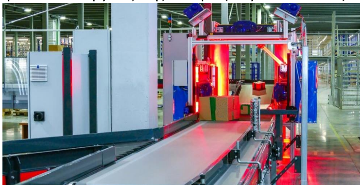
Εικόνα 12: Σύστημα Μηχανική Όρασης
