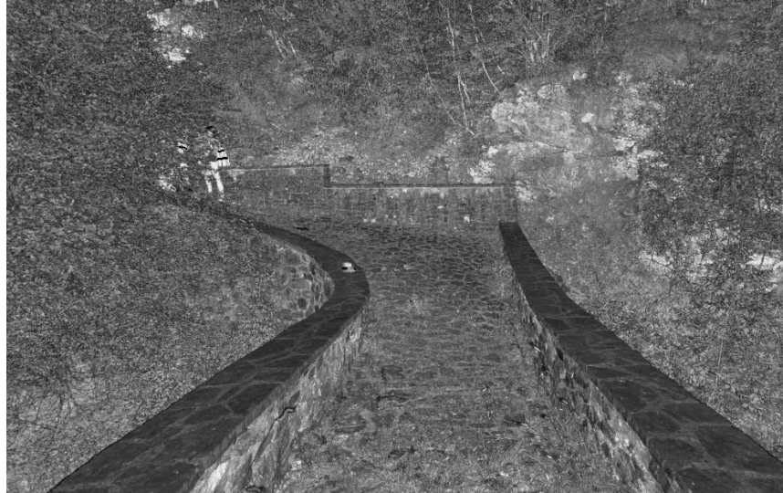
6.34: Νέφος σημείων από τρισδιάστατη σάρωση με Laser scanner Πηγή: Τμήμα Τοπογράφων και Γεωπληροφορικής του Πανεπιστημίου Δυτικής Αττικής
