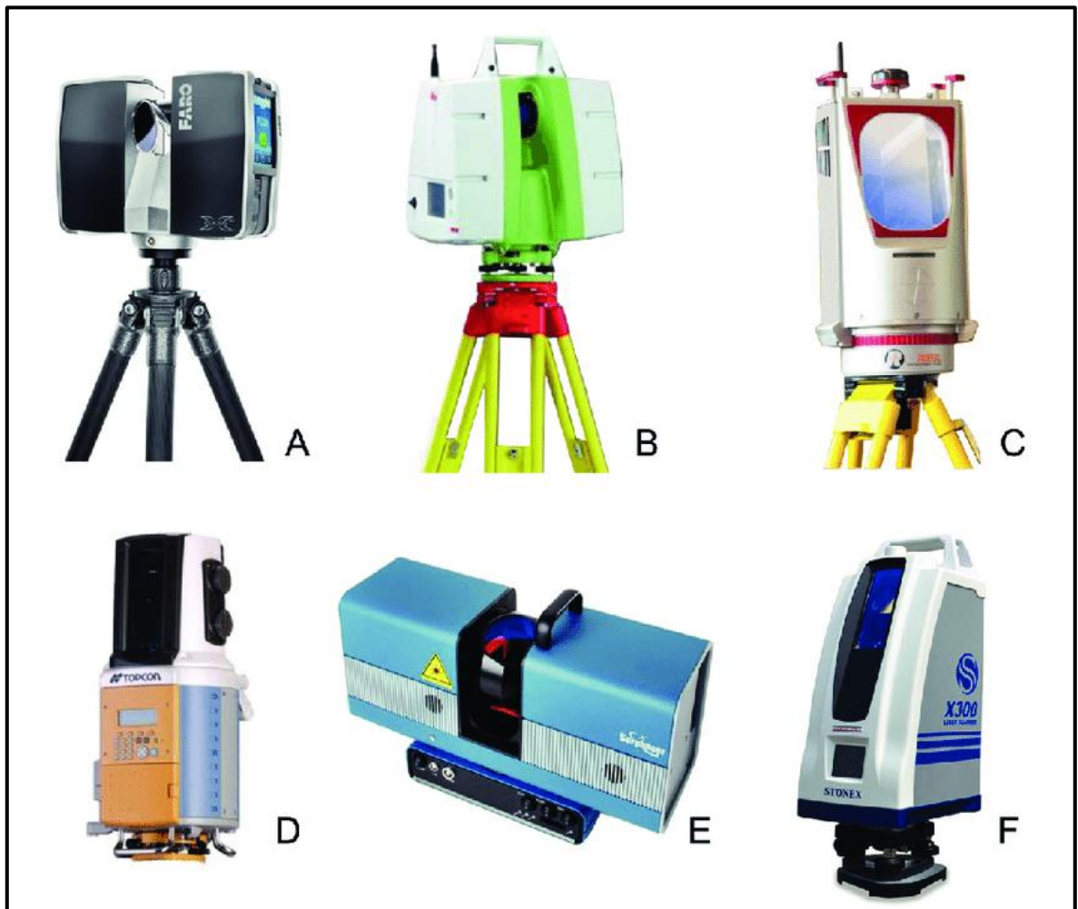
Εικόνα 1: Είδη Επίγειων σαρωτών laser. Πηγή: https://www.researchgate.net/
