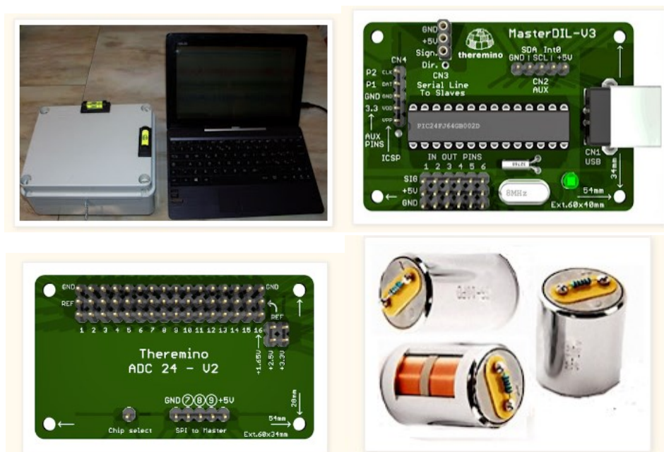
Εικόνα 23 - Πειραματικός 24 bit Σεισμογράφος
