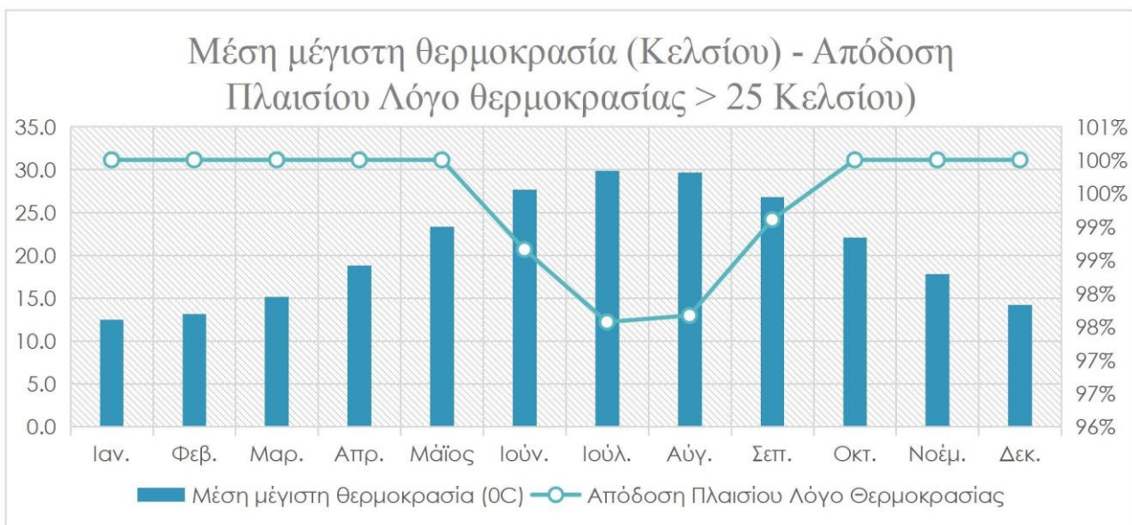
Πίνακας 4: Μέση μέγιστη θερμοκρασία ανά μήνα στην χώρα μας Κα η απόδοση ενός ηλιακού πλαισίου όταν Θερμοκρασία πλαισίου είναι > 25 °C
