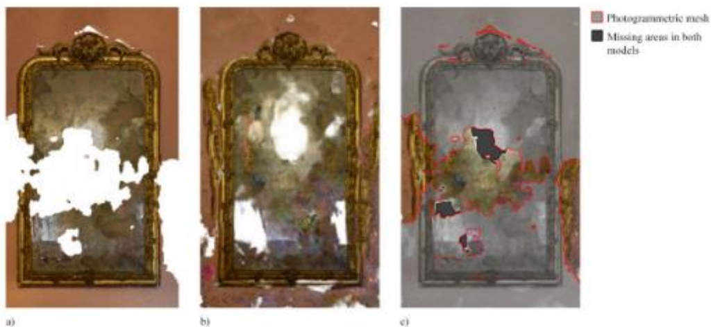
Εικόνα 96: Καθρέφτης: (α) φωτογραμμτρικό πλέγμα, (β) ογκομετρική απόδοση που δημιουργείται από το NeRF (γ) συγκριτική υπέρθεση των δύο διαφορετικών αποτελεσμάτων
