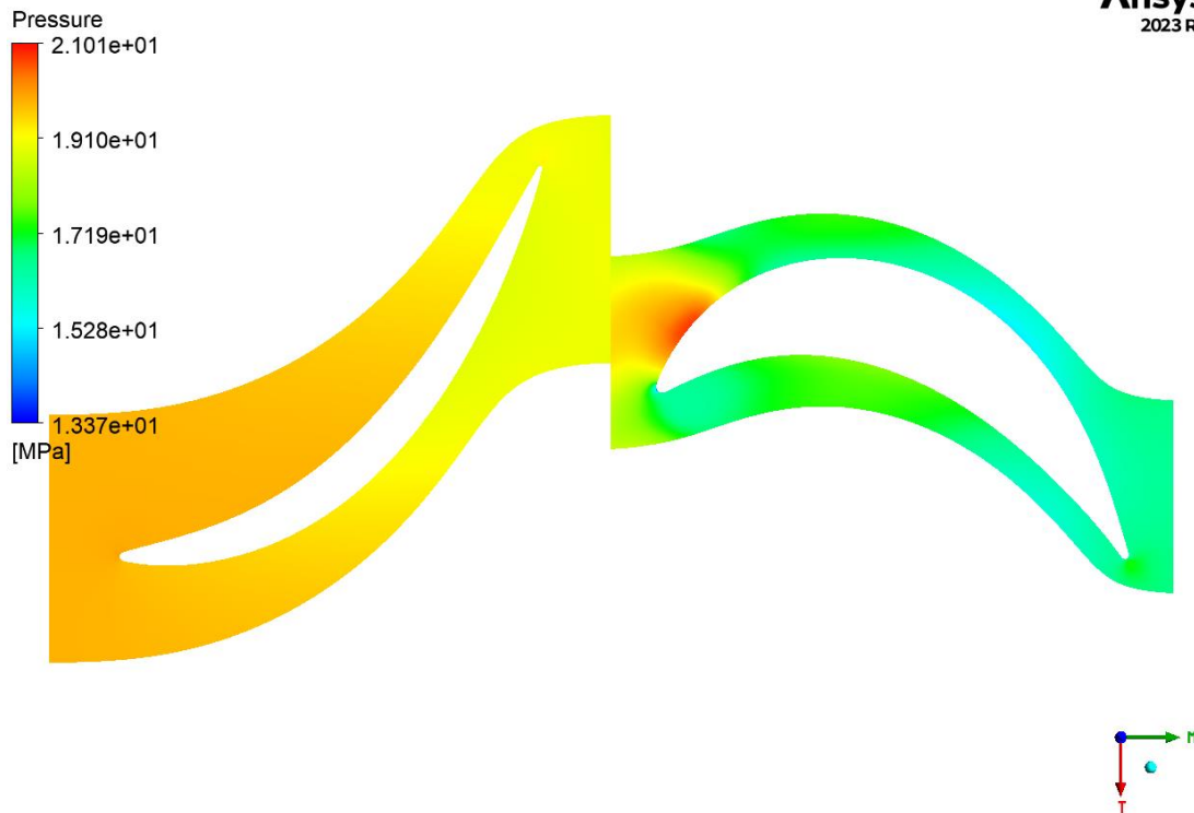
Εικόνα 4.4.3.3: Κατανομή της πίεσης στο 90% του ύψους των πτερυγίων.
