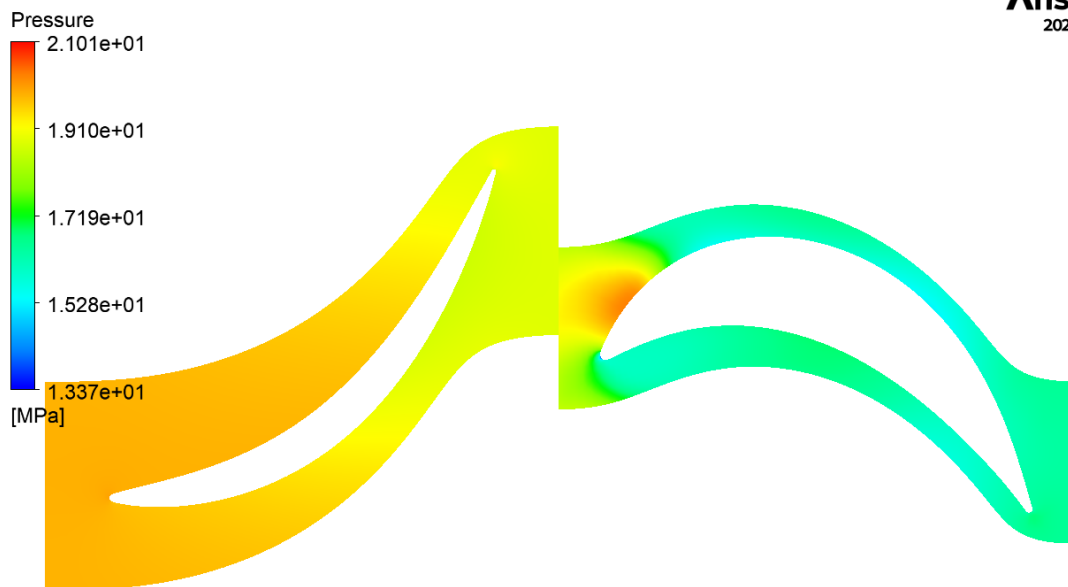
Εικόνα 4.4.3.1: Κατανομή της πίεσης στο 10% του ύψους των περυγίων.
