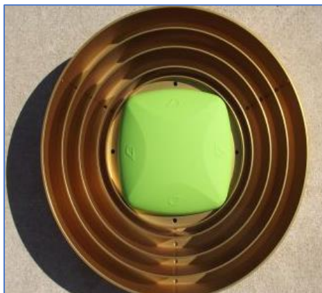
Εικόνα 3.23: Η εξωτερική κεραία με choke rings (Πηγή: https://www.ngs.noaa.gov/ANTCAL/index.xhtml?manu=Javad%20GNSS%20Inc. )
