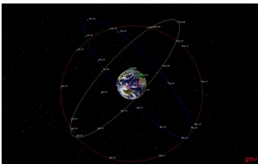
Εικόνα 2.4: Αστερισμός δορυφόρων Galileo (gmv.com)
