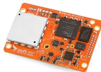
Εικόνα 4.13: Δέκτης Piksi® Multi (canalgeomatics.com)
