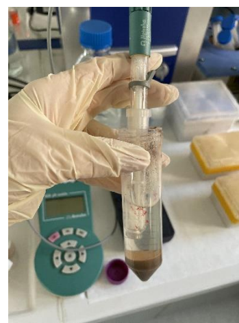
Εικόνα 48: Μέτρηση του pH του αιωρήματος (Εργαστήριο ΕΠΕΥ)
