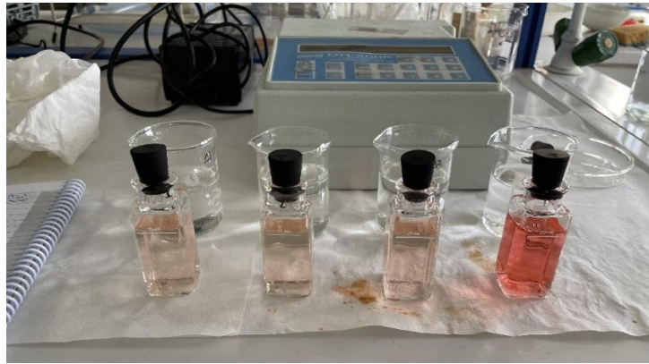
Εικόνα 28: Αντίδραση δειγμάτων νιτρωδών ιόντων, όπου όσο εντονότερος ο ροζ χρωματισμός τόσο μεγαλύτερη η συγκέντρωση \text{NO}_2
