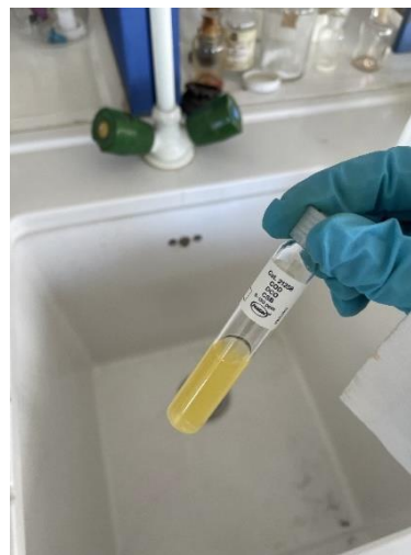
Εικόνα 36: Ανάδευση δείγματος υπό γωνία 45°
