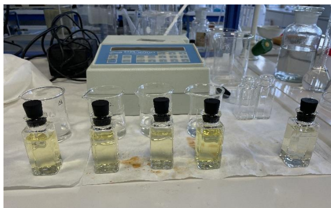
Εικόνα 30: Αντίδραση δειγμάτων νιτρικών ιόντων, όπου όσο εντονότερος ο κίτρινος χρωματισμός τόσο μεγαλύτερη η συγκέντρωση \text{NO}_3^-
