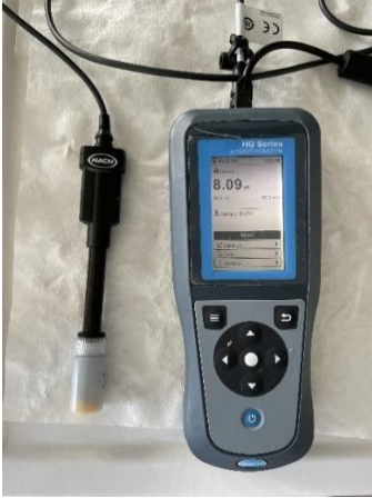
Εικόνα 3: Όργανο μέτρησης pH (LANGE pH101) (Εργαστήριο ΕΠΕΥ)
