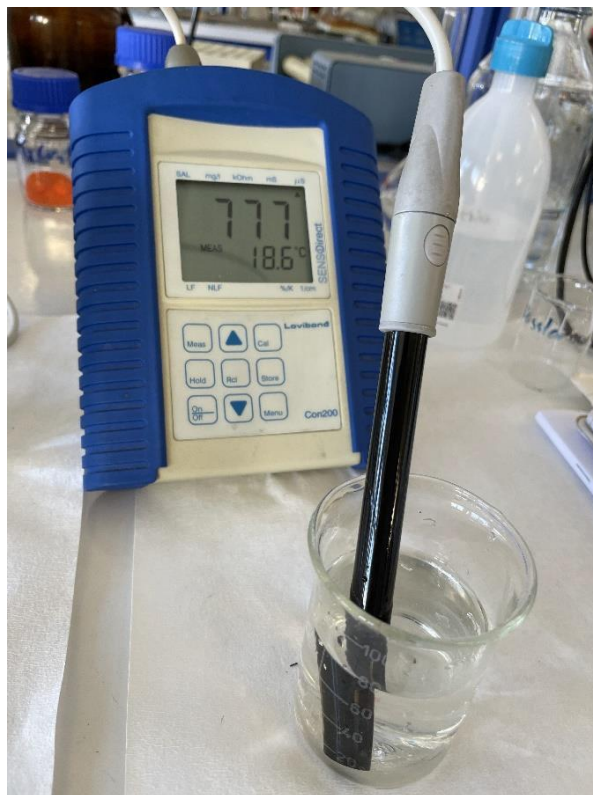
Εικόνα 10: Αγωγιμόμετρο LOVIBOND SENSODirect Con200 για μέτρηση αγωγιμότητας και θερμοκρασίας σε δείγμα ( \mu\text{S}/\text{cm} )
