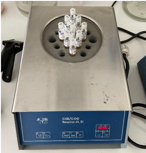
Εικόνα 37: Χώνευση δειγμάτων COD για 2 ώρες (Εργαστήριο ΕΠΕΥ)
