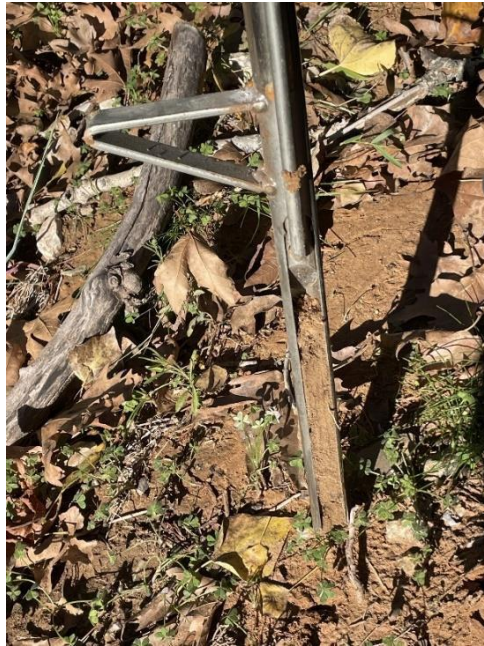
Εικόνα 40: Λήψη δείγματος εδάφους με ειδικό εξοπλισμό (καρότο)
