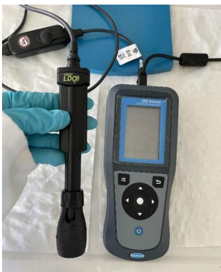
Εικόνα 34: Οξυγονόμετρο HACH (LANGE LDO101) (Εργαστήριο ΕΠΕΥ)
