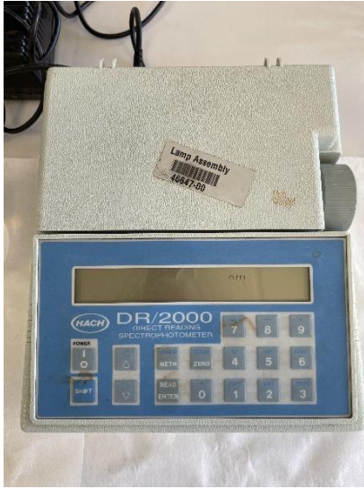
Εικόνα 26: Φασματοφωτόμετρο HACH DR/200 (Εργαστήριο ΕΠΕΥ)
