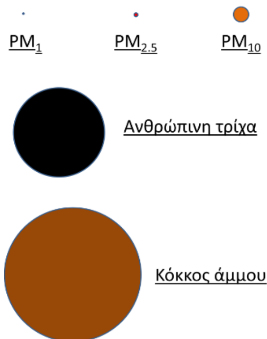
Σχήμα 1.3: Συγκριτική τάξη μεγέθους των αιωρούμενων σωματιδίων. [4]
