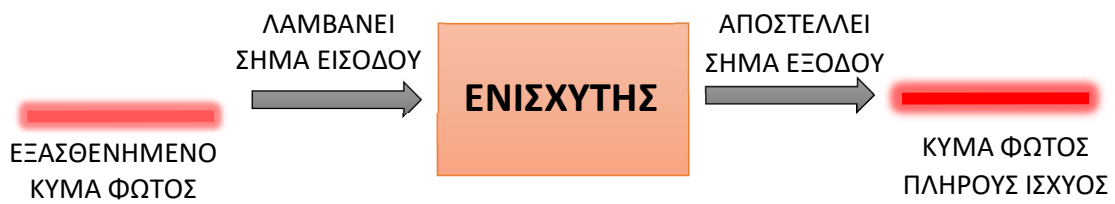
Σχήμα 3.3: Λειτουργία Ενισχυτή σε Δίκτυο Οπτικών Ινών
