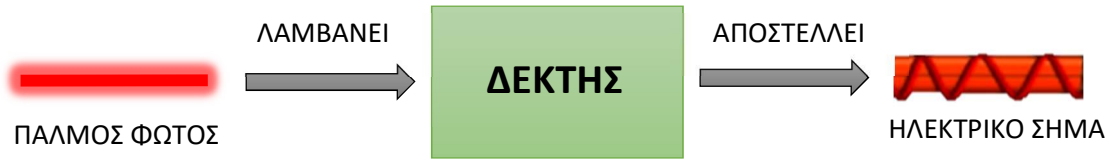
Σχήμα 3.2: Λειτουργία Δέκτη σε Δίκτυο Οπτικών Ινών
