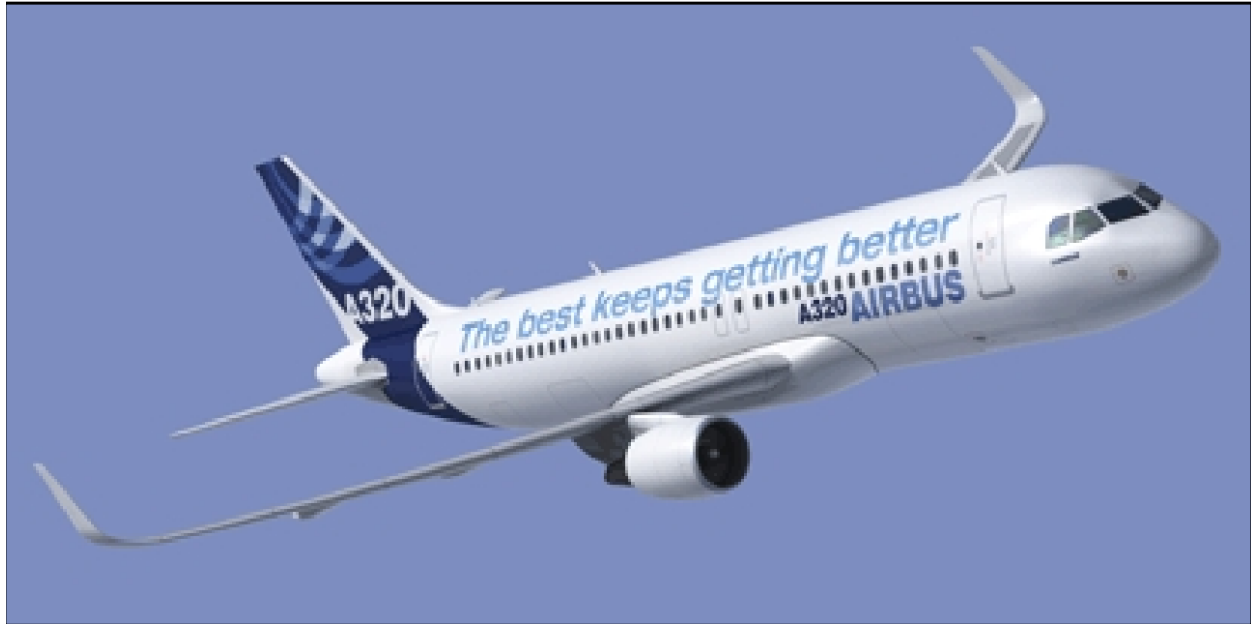
Εικόνα 9: Sharklets στο Airbus A320
