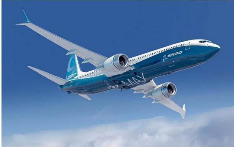
Εικόνα 8: Winglets στο B737 MAX
