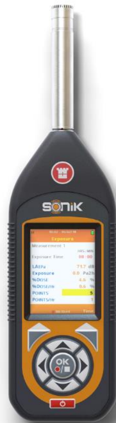
Εικόνα 3.2 Ηχόμετρο εργαστηρίου ΗΜΕ & ΠροΠε
