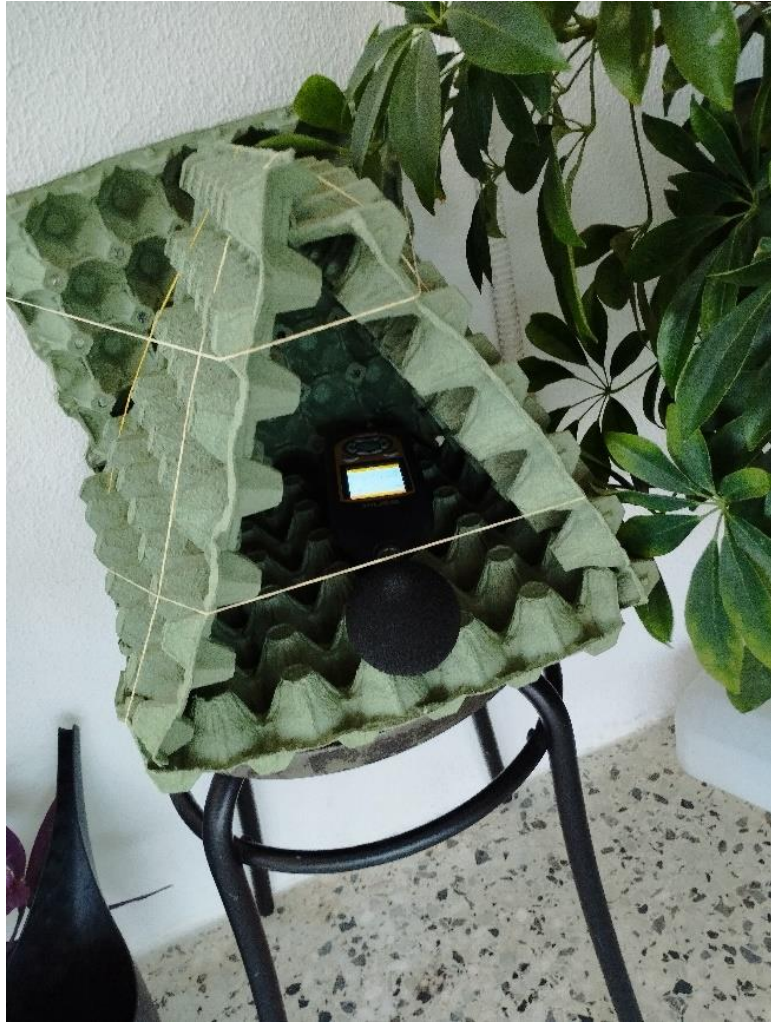
Εικόνα 6.7 Κατασκευή εγκατάστασης ηχομέτρου
