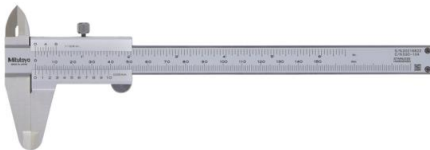
Εικόνα 2.34: Το αναλογικό παχύμετρο με το οποίο μετρήθηκαν διαστάσεις [187].
