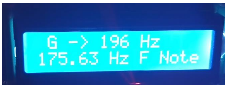
Εικόνα 3.12: Το μήνυμα που εμφανίζει την επιθυμητή συχνότητα ταλάντωσης της χορδής Σολ (G) [253].
