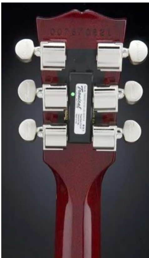
Εικόνα 1.32: Το Power Tune Systems της Tronical Company στις Gibson Robot Guitars [79].
