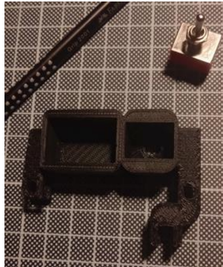
Εικόνα 2.87: Η βάση στήριξης του τριπολικού διακόπτη και της επαναφορτιζόμενης μπαταρίας των 9 Volt μετά την ολοκλήρωση της τρισδιάστατης εκτύπωσης [240].
