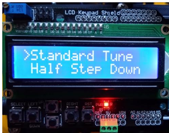
Εικόνα 3.39: Το μενού για την επιλογή κουρδίσματος ή του χειροκίνητου ελέγχου του συστήματος [280].
