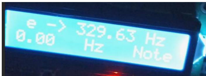
Εικόνα 3.52: Το μήνυμα που εμφανίζει την επιθυμητή συχνότητα ταλάντωσης της χορδής Μι (e) [293].
