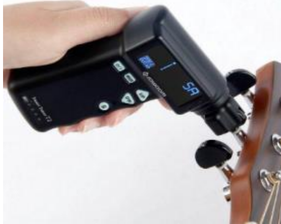
Εικόνα 1.74: Το κουρδιστήρι Automatic crank tuner από την εταιρία Jowoom [121]
