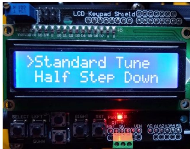
Εικόνα 3.21: Το μενού για την επιλογή κουρδίσματος ή του χειροκίνητου ελέγχου του συστήματος [262].
