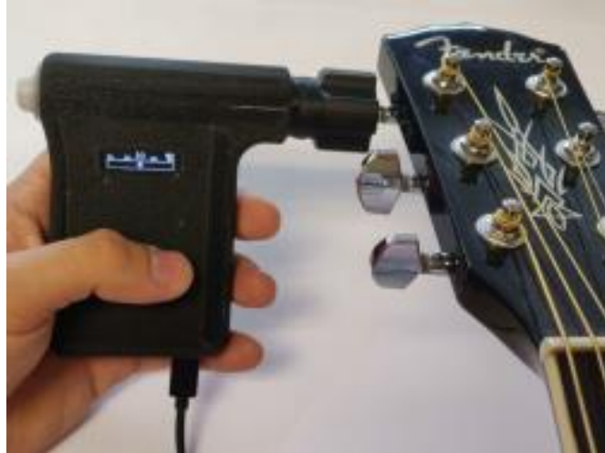
Εικόνα 1.67: Χρήση του πρωτότυπου συστήματος για το κούρδισμα της PE (D3) χορδής [114].
