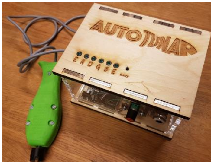
Εικόνα 1.52: Το τελικό σύστημα του Robotic Electric Guitar Tuner [99].
