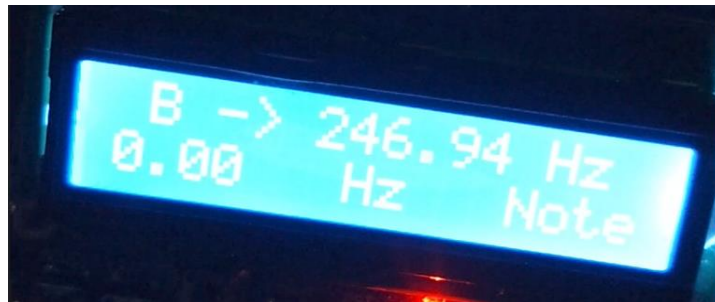
Εικόνα 3.14: Το μήνυμα που εμφανίζει την επιθυμητή συχνότητα ταλάντωσης της χορδής Σι (B) [255].
