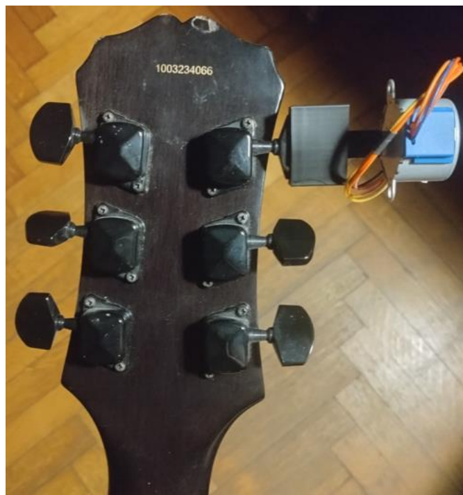
Εικόνα 2.42: Εφαρμογή του βηματικού κινητήρα επάνω στο κλειδί της κιθάρας με την χρήση του αντάπτορα [195].
