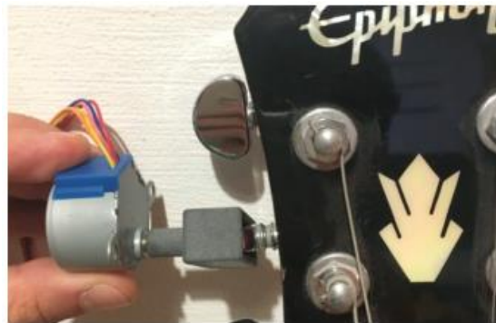
Εικόνα 1.79: Ο βηματικός κινητήρας με τον αντάπτορα για την περιστροφή του κλειδιού [126]
