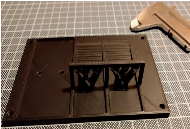
Εικόνα 2.65: Η βάση στήριξης των μπαταριών και οι σύνδεσμοι σταθεροποίησης της επάνω στους αντάπτορες [218].
