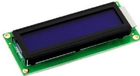
Εικόνα 2.8: Απλή οθόνη LCD 16 χαρακτήρων και 2 σειρών [161].
