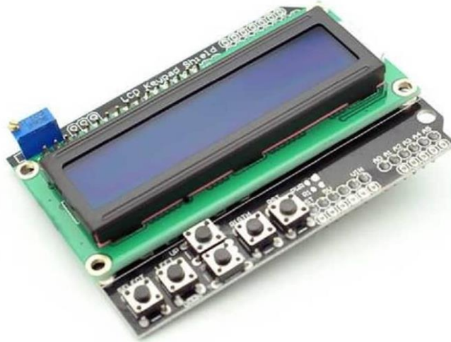
Εικόνα 2.27: Η LCD οθόνη 16x02 με ενσωματωμένο πληκτρολόγιο [180].
