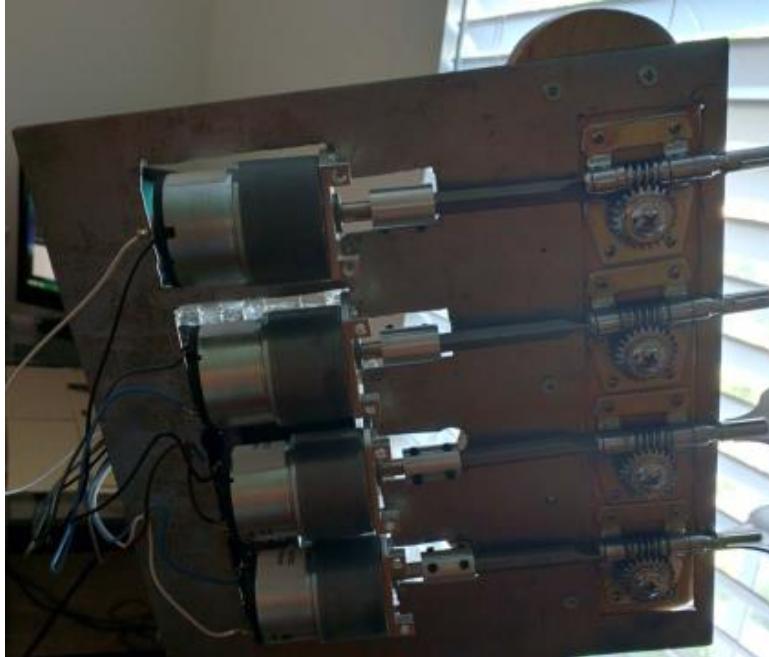
Εικόνα 1.60: Η βάση από λαμαρίνα με τους κινητήρες συνδεδεμένους πάνω στα κλειδιά του μπάσου [107].
