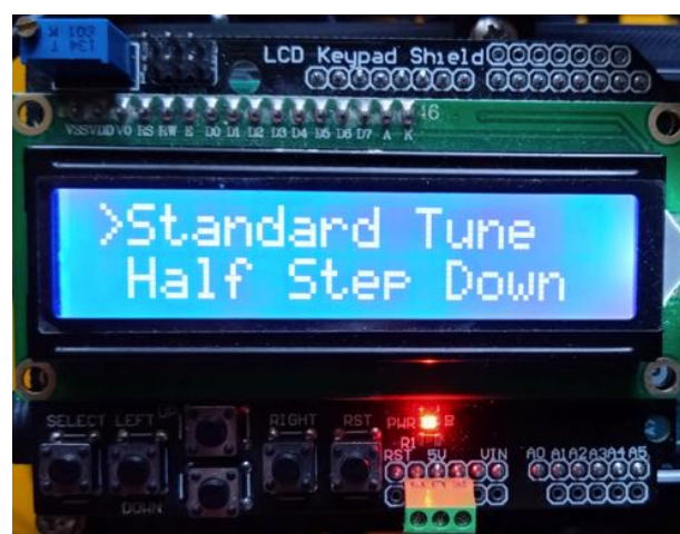
Εικόνα 3.57: Το μενού για την επιλογή κουρδίσματος ή του χειροκίνητου ελέγχου του συστήματος [298].
