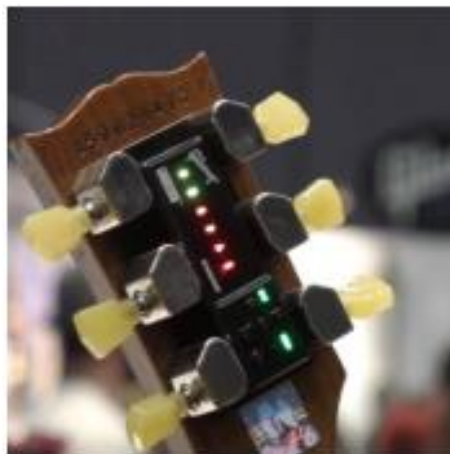
Εικόνα 1.73: Το αυτόματο κουρδιστήρι Power Tune από την Tronical που χρησιμοποιεί η Gibson [120]
