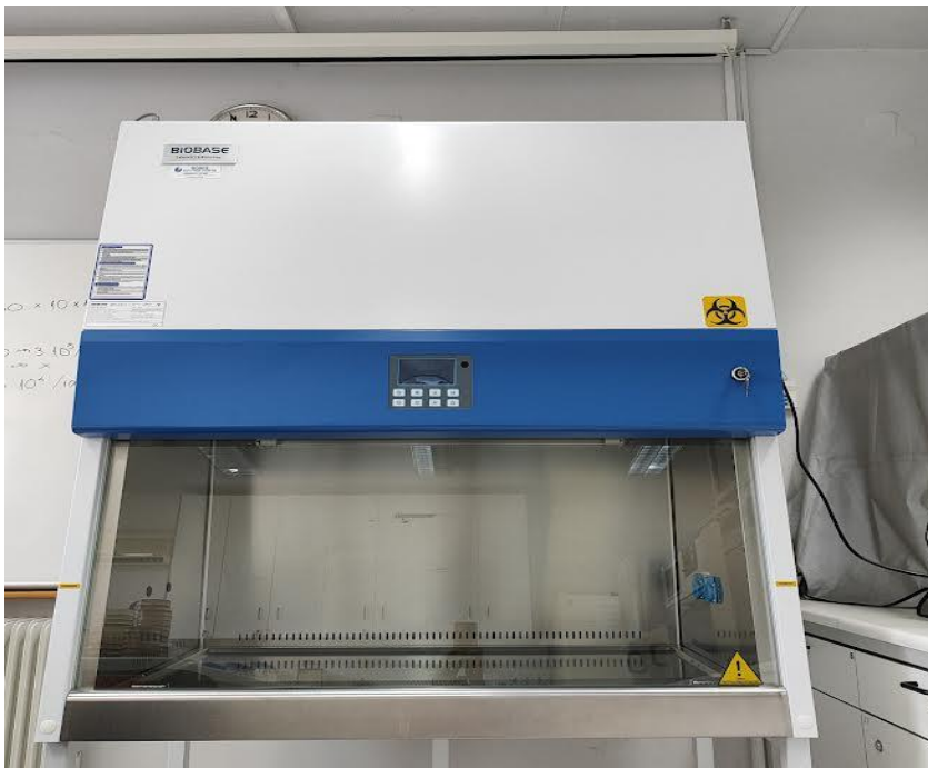
Εικόνα 3.7: Θάλαμος Βιοασφάλειας class II
