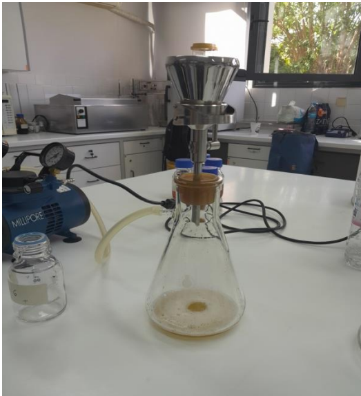
Εικόνα 3.25: Φιλτράρισμα δειγμάτων με αντλία κενού
