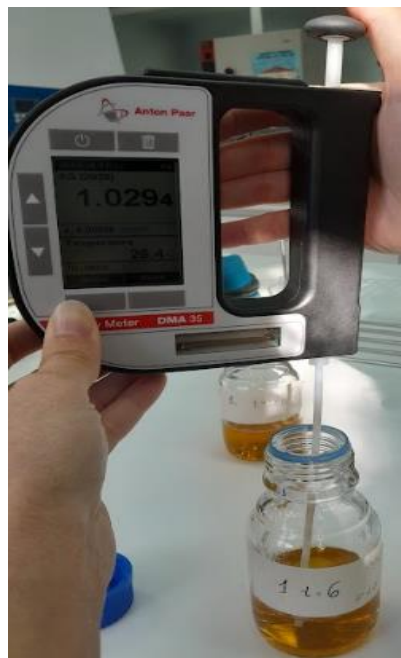
Εικόνα 3.36: Μέτρηση των ολικών στερεών των δειγμάτων με το Handheld density meter DMA 35, Anton Paar
