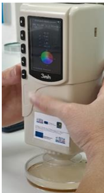
Εικόνα 3.33: Μέτρηση χρώματος δειγμάτων με το χρωματόμετρο Precision colorimeter NR110
