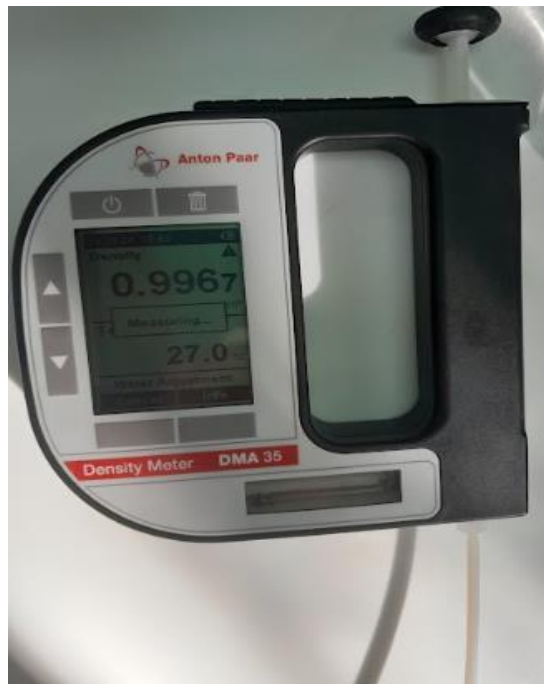
Εικόνα 3.35: Handheld density meter DMA 35, Anton Paar
