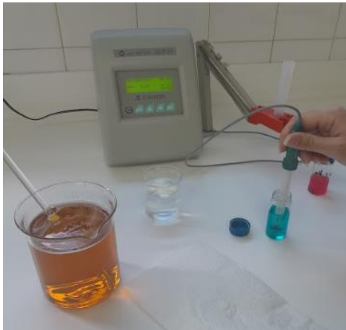
Εικόνα 3.30: Καλιμπράρισμα οργάνου pH METER GLP 21 CRISO
