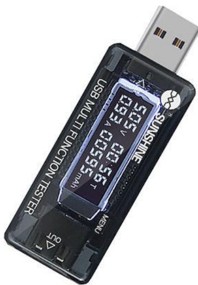
Εικόνα 8.1: Η συσκευή USB-A για μέτρηση της τάσης και της έντασης ρεύματος [57]
