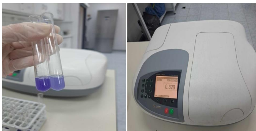
Εικόνα 8. Μέθοδος FRAP στο εργαστήριο: 1) Χαρακτηριστικό μπλε χρώμα, η ένταση του οποίου αλλάζει ανάλογα την αντιοξειδωτική ικανότητα του καθενός δείγματος και 2) Φωτόμετρο για την μέτρηση της απορρόφησης (προσωπικό αρχείο)
