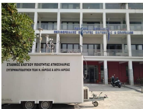
Εικόνα 3.1 Σταθμός μέτρησης αερορύπανσης στο προαύλιο της Περιφερειακής Ενότητας Μαγνησίας [72]
