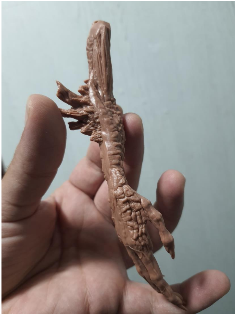
6.4 Το χέρι της φιγούρας αφού έχει γίνει καθάρισμα και cure σε υν φώς.
