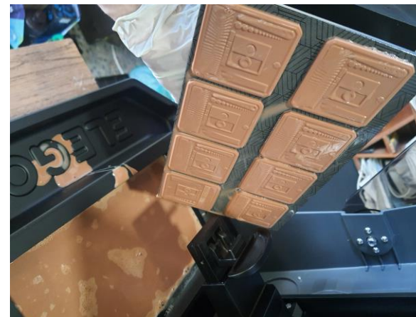
6.0 Το αρχείο αυτό είναι γρήγορο στην εκτύπωση και επιτρέπει το cure time calibration.
