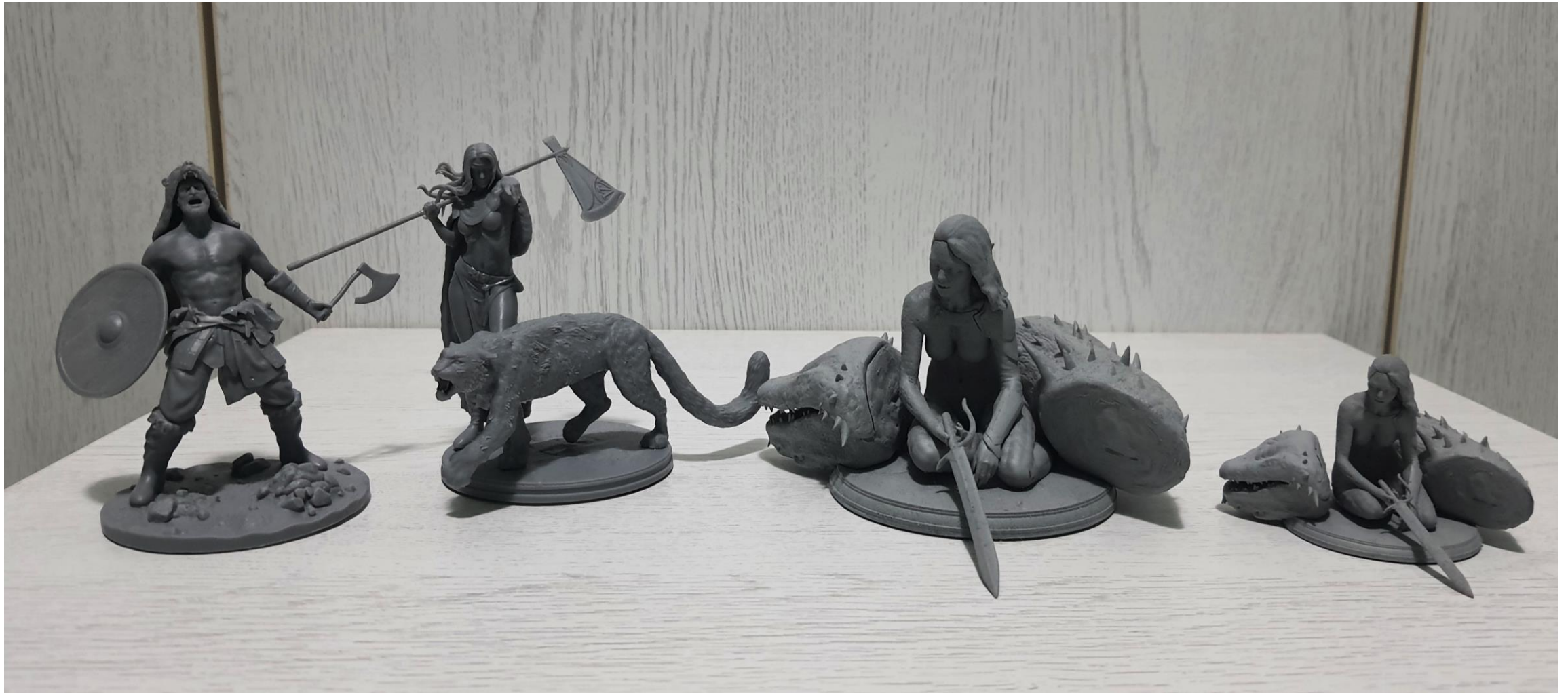
7.3 Εκτύπωση διαφορετικών φιγούρων. Οι εκτυπώσεις έγιναν σε εκτυπωτή Form 3+ και Anycubic Photon. Οι εκτυπώσεις έχουν ασταρωθεί με αστάρι σε σπρέι χρώματος γκρι.
