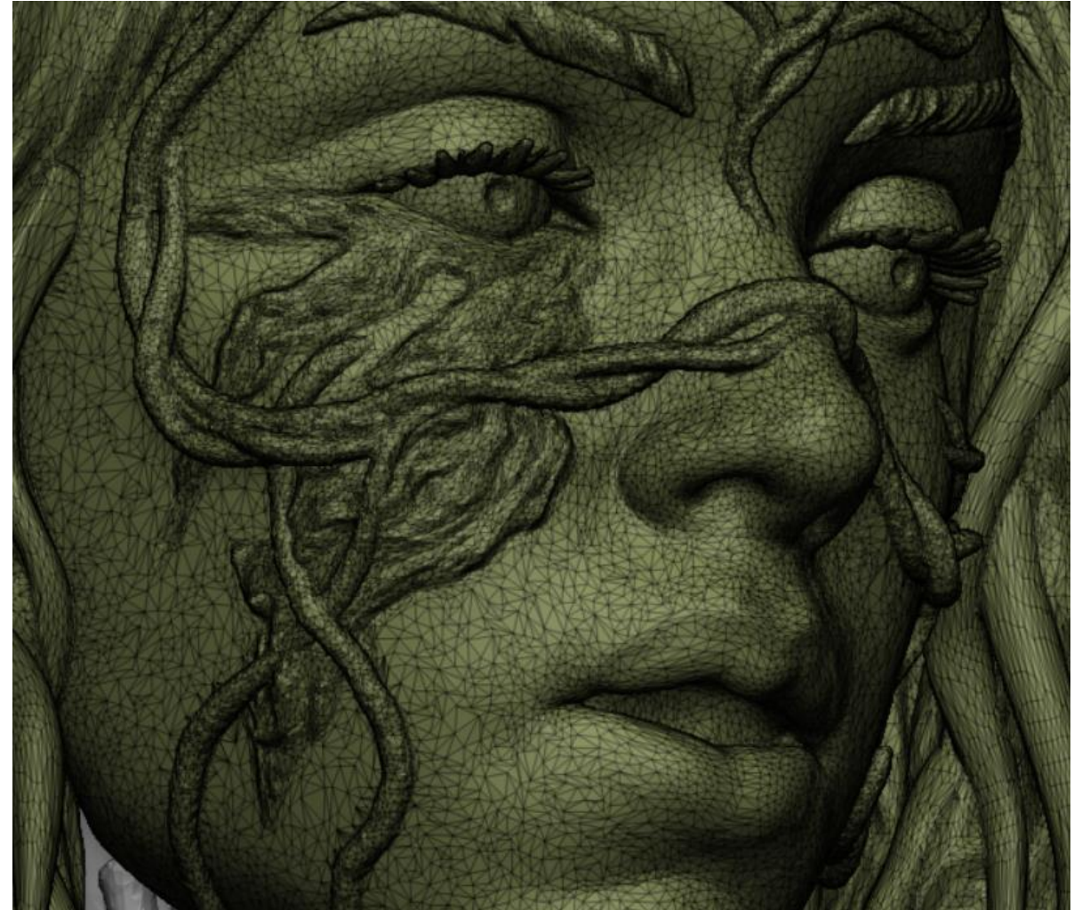
5.1 Decimation με το Decimation Master, είναι φανερό η πυκνότητα των πολυγώνων σε σχέση με την λεπτομέρεια κάθε περιοχής.
