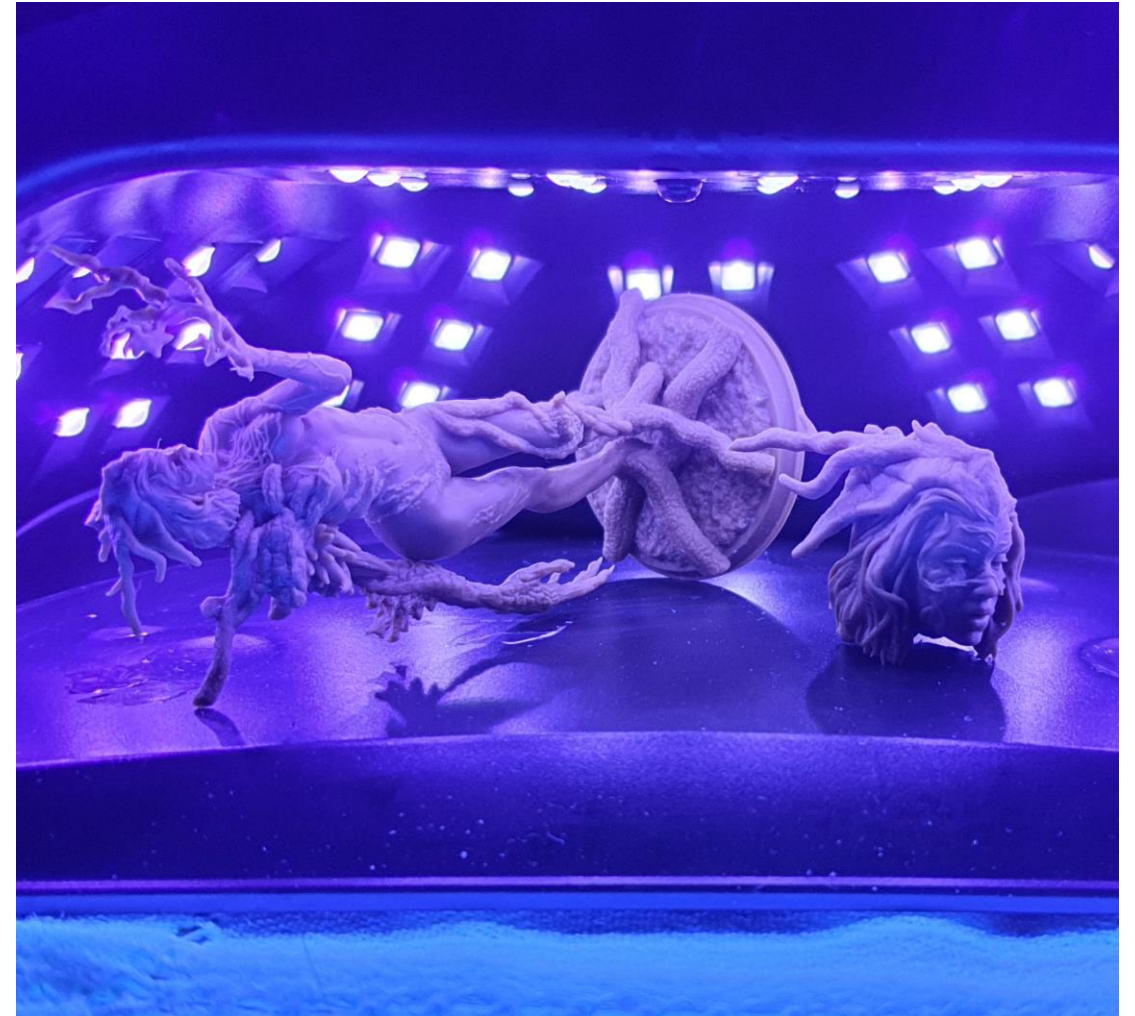
6.7 Curing τα κομμάτια της φιγούρας στην λάμπα UV για την τελική τους σκλήρυνση.
