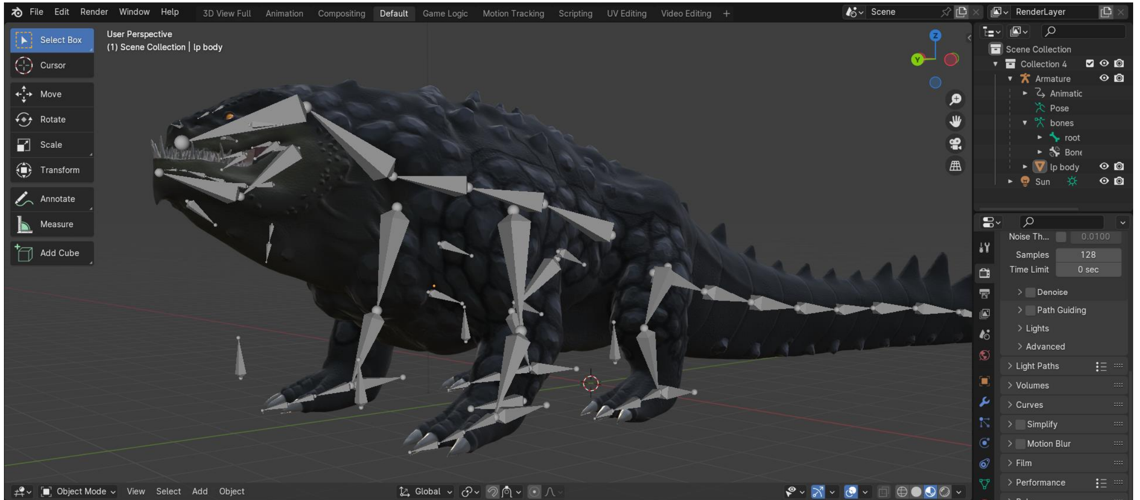
7.14 Το armature που αποτελείται από ένα απλό bone construction με 1 parenting bone και αρκετά IK bones.
