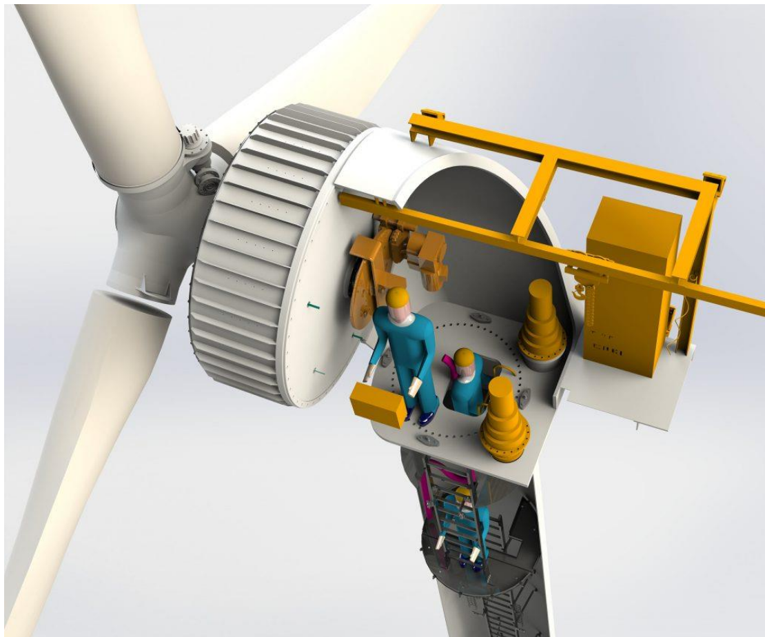
Εικόνα 18: Εσωτερικό πύργου στο σημείο σύνδεσης με το θάλαμο (Πηγή)
