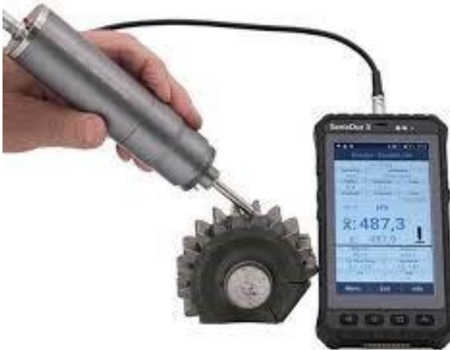
Σχήμα 4. Διαδικασία μέτρησης με χρήση του Φορητού Σκληρόμετρου Υπερήχων (UCI)
