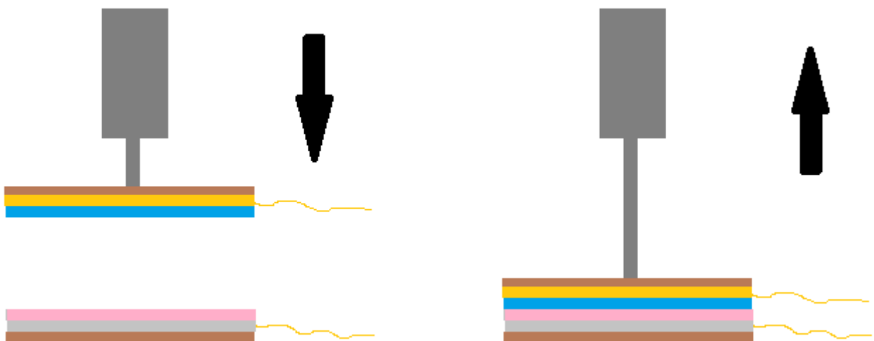
Εικόνα 6.7 Αρχή λειτουργίας της συσκευής: Ξύλινη επιφάνεια, FR4 Board, PE, υπό δοκιμή υλικό, ταινία αλουμινίου, Ξύλινη επιφάνεια.
