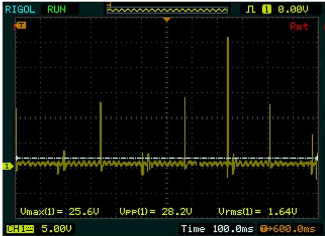
Εικόνα 6.17: Λεπτομερής απεικόνιση 24VDC 3HZ το μεγαλύτερο peak σε δείγμα 72 χτύπων για το υφαντό με επίστρωση Τεφλόν.
