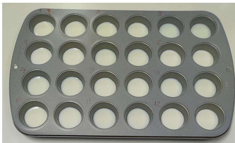
Εικόνα 2.2 Δείγματα γάλακτος πριν τη λυοφιλίωση, τοποθέτηση σε φόρμες
