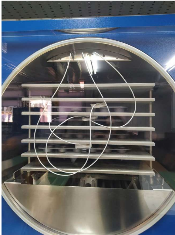
Εικόνα 2.3 Τοποθέτηση δειγμάτων στον λυοφιλιωτή, σύνδεση θερμοστοιχείων
