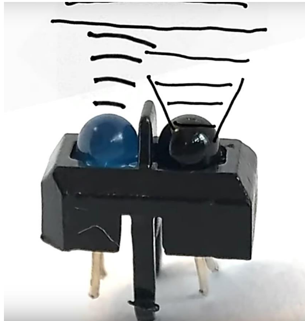
Εικόνα 2.13: Τρόπος εκπομπής – λήψης αισθητήρα
